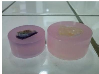
Figura 29: Probetas finales tras el proceso de desbaste y pulido.
