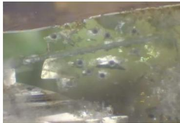
Figura 53: Puntos de ablación en la fluorita de Durham.
