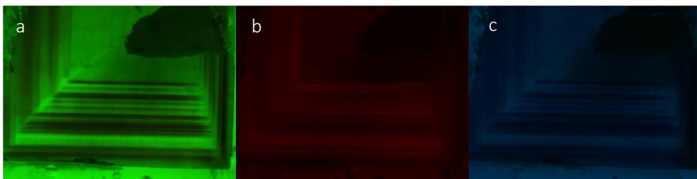
Figura 32: Fluorita de Berbes vista en el microscopio con distintas longitudes de onda de excitación: 395-455 nm (a), 510-560 nm (b), 340-380 nm (c).
