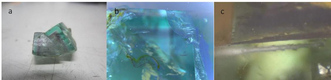
Figura 43: Fluorita de Durham antes de prepararla para la ablación (a), una vez preparada y vista en el microscopio (b) y en la cámara de ablación después de realizar una línea de ablación (c).
