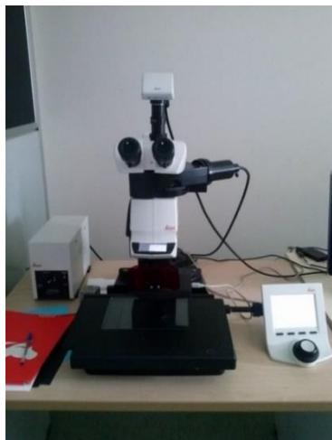
Figura 30: Microscopio estereoscópico de la marca Leica.
