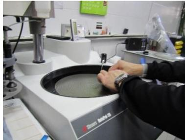
Figura 26: Proceso de desbaste y pulido a mano.
