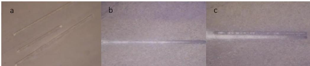
Figura 39: líneas de ablación de la resina (a), fuera de las líneas de crecimiento (b), dentro de las líneas de crecimiento (c).
