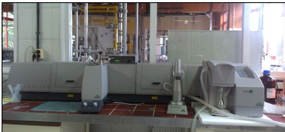
Figura 20. Mastersizer empleado en la determinación de la distribución del tamaño de las partículas
