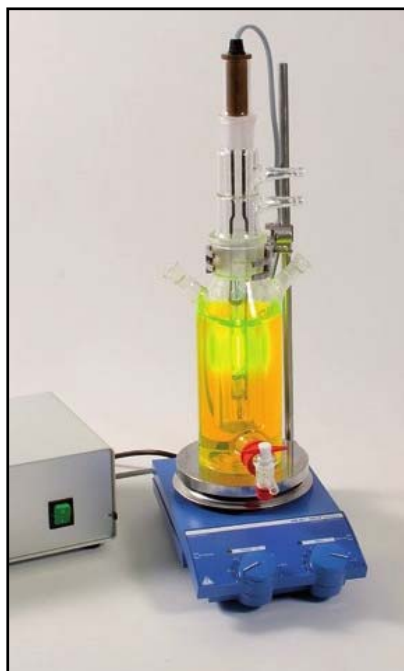
Figura 19. Reactor UV empleado para la síntesis de polímeros
