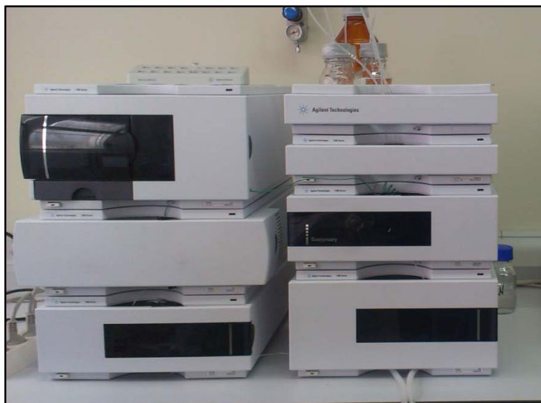
Figura 17. Cromatógrafo de líquidos de alta eficacia (HPLC) empleado en las determinaciones analíticas
