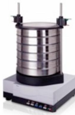
*Fig. 3.6: Tamizadora utilizada*
