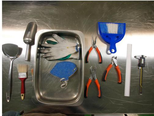
*Fig. 3.1: Útiles empleados en la preparación mecánica del material*
