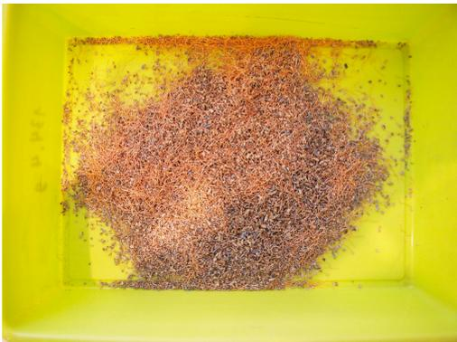
Fig. 3.48: Resultado obtenido en el tamiz con partículas 1-2 mm
