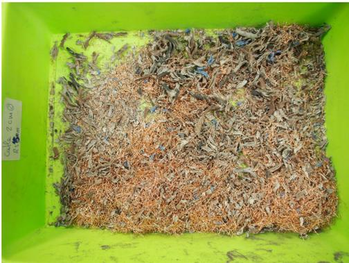
Fig. 3.39: Resultado de la muestra tras la trituración de cables de 2 cm
