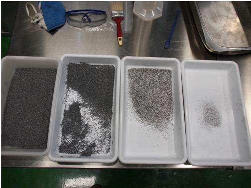
Fig. 3.104: Material obtenido tras la separación del material triturado a 2 mm
