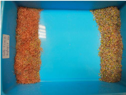
Fig. 3.74: Resultado de la muestra tras la trituración de cables de 2 cm
