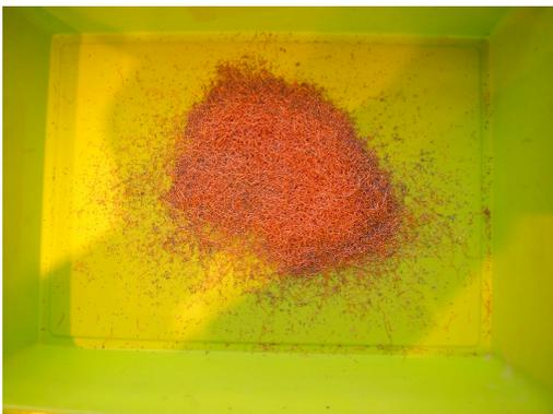
Fig. 3.50: Resultado obtenido en el tamiz con partículas 500-250 µm
