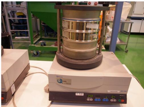
Fig. 3.44: Tamizadora eléctrica
