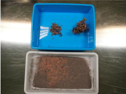
Fig. 3.25: a) Resultado de la muestras tras la trituración de cables de 6 cm
