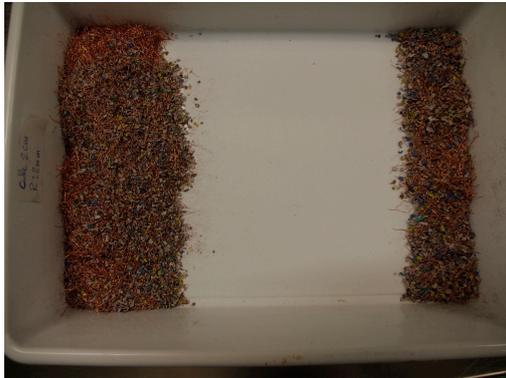
Fig. 3.89: Resultado de la muestra tras la trituración de cables de 2 cm
