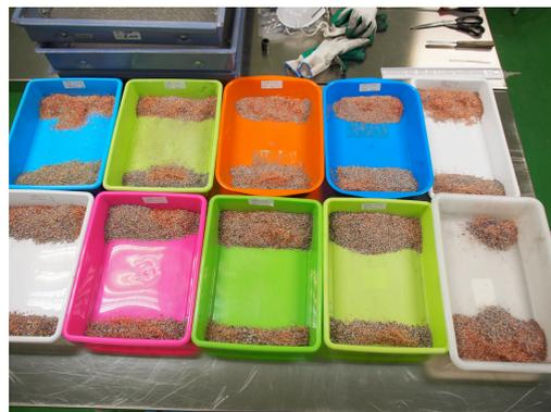
Fig. 3.94: Comparativa de los resultados de las muestras tras la trituración con reglajes de 1 y 2 mm
