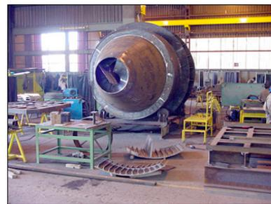
Fig. 8: (a) y (b) Fabricación de un Molino Autógeno [7]
