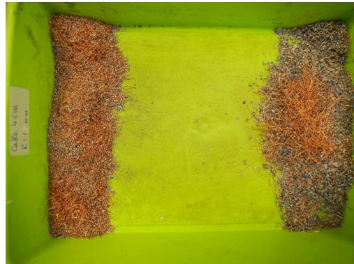
Fig. 3.75: Resultado de la muestra tras la trituración de cables de 4 cm
