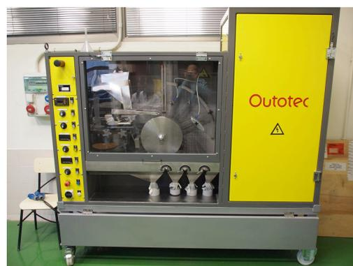
Fig. 3.1098 Separador electrostático de alta tensión OUTOTEC.
