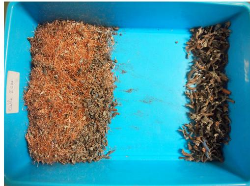
Fig. 3.40: Resultado de la muestra tras la trituración de cables de 4 cm.
