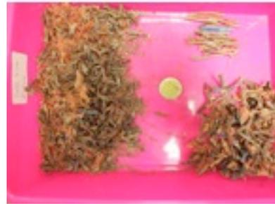
Fig. 3.61: Resultado de la muestra tras la trituración de cables de 4 cm
