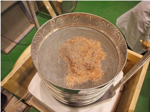
Fig. 3.28: Muestra sobre el tamiz de 3,35 mm
