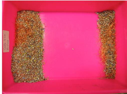
Fig. 3.90: Resultado de la muestra tras la trituración de cables de 4 cm
