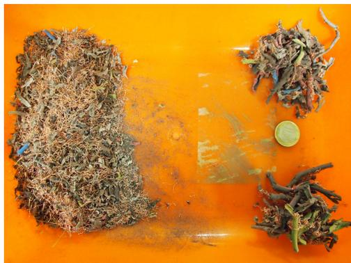
Fig. 3.43: Resultado de la muestra tras la trituración de cables de 18 cm
