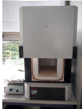
*Fig. 3.100: Horno de mufla utilizado*
