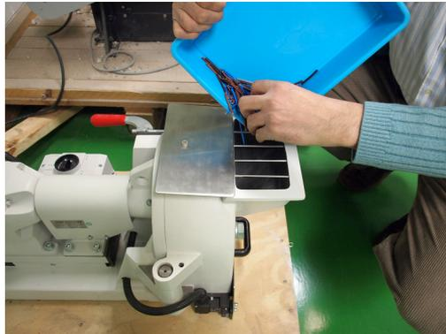
Fig. 3.38: Introducción del material a triturar
