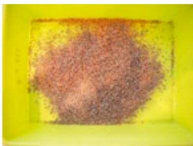
Fig. 3.83: Resultado obtenido en el tamiz con partículas entre 2-1 mm.
