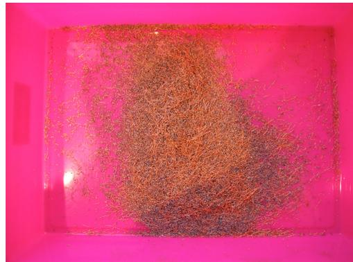
Fig. 3.49: Resultado obtenido en el tamiz con partículas entre 1-500 µm
