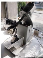
Fig. 3.112: a) Celda de flotación empleada
