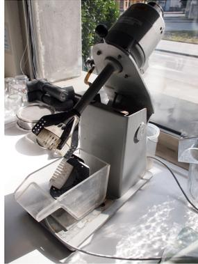
*Fig. 3.97: Celda de flotación por espumas*
