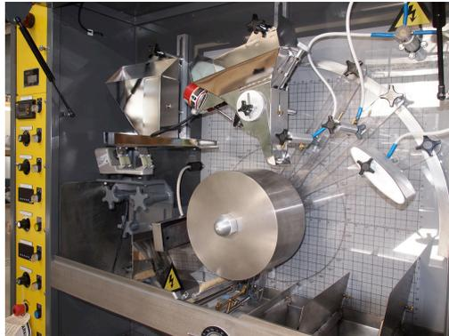
Fig. 3.101: Separador de alta tensión
