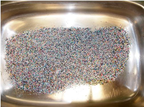
Fig. 3.106: Partículas No Conductoras < 1 mm
