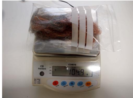
Fig. 3.14: Pesaje del material conductor antes de triturar
