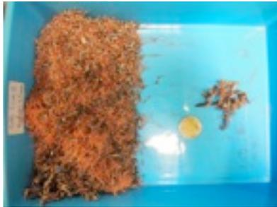
Fig. 3.54: Resultado de la muestra tras la trituración de cables de 2 cm (1º caso)
