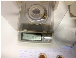
Figura 3.113: a) Báscula de precisión empleada
