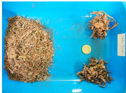
Fig. 3.42: Resultado de la muestra tras la trituración de cables de 9 cm
