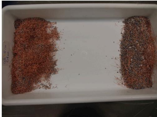
Fig. 3.78: Resultado de la muestra tras la trituración de cables de 18 cm
