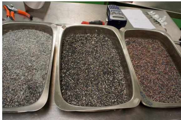
Fig. 3.11: Material triturado a 2 mm
