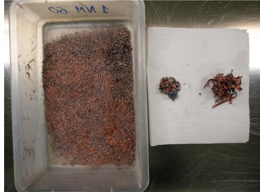
Fig. 3.25: b) Resultado de la muestras tras la trituración de cables de 9 cm
