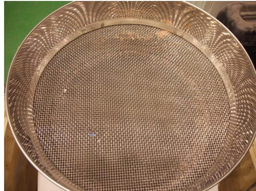
Fig. 3.29: Resultado obtenido en el tamiz de 3,35 mm
