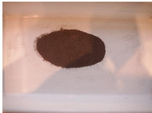
Fig. 3.51: Resultado obtenido en el tamiz con partículas menores de 250 µm
