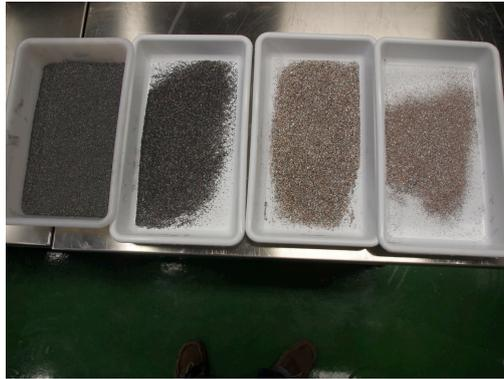
Figura 3.103. Muestras obtenidas tras la separación con partículas < 1 mm
