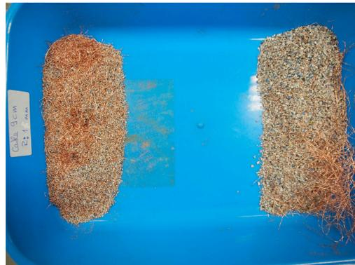
Fig. 3.77: Resultado de la muestra tras la trituración de cables de 9 cm
