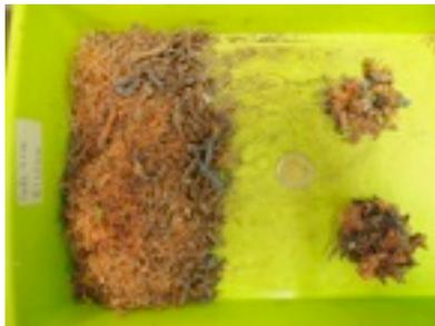
Fig. 3.56: Resultado de la muestra tras la trituración de cables de 4 cm
