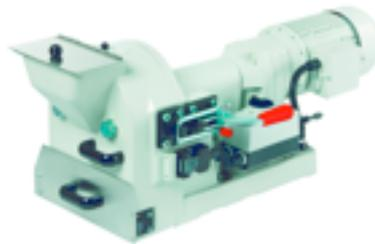
*Fig. 3.3: Trituradora de discos utilizada*
