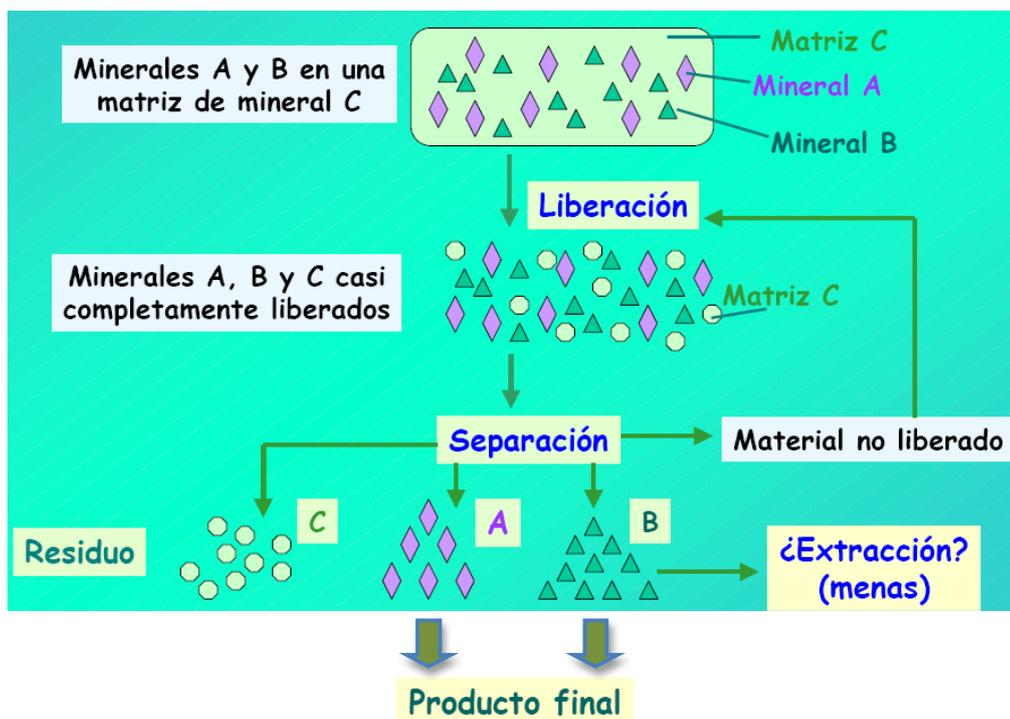
Fig. 1: Esquema de una planta de tratamiento de materiales mineralógicos
