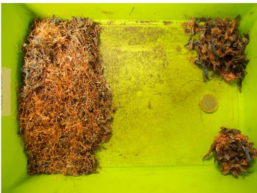
Fig. 3.41: Resultado de la muestra tras la trituración de cables de 6 cm
