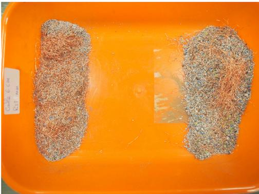
Fig. 3.76: Resultado de la muestra tras la trituración de cables de 6 cm
