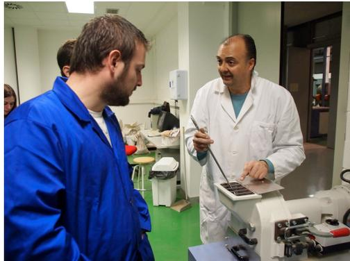
Fig. 3.73: Introducción del material a triturar
