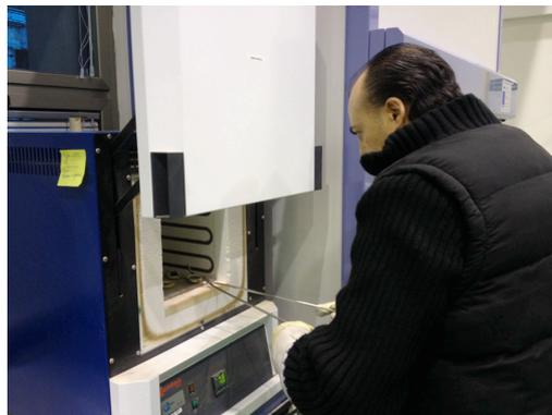
Fig. 3.96: Crisoles, guantes y pinzas empleados en la calcinación del material
