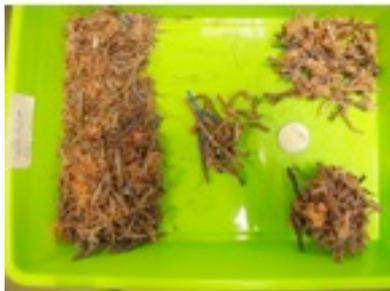
Fig. 3.62: Resultado de la muestra tras la trituración de cables de 6 cm
