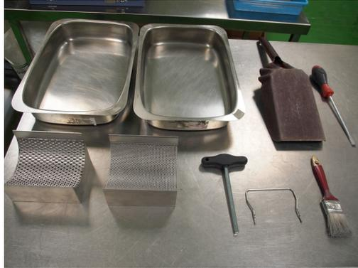
Figura 3.10: Cribas de 2 y 1 mm y útiles para la trituración
