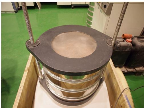
Fig. 3.109: Tamizadora eléctrica utilizada
