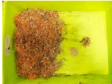
Fig. 3.55: Resultado de la muestra tras la trituración de cables de 2 cm (2º caso)
