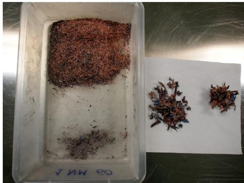
Fig. 3.25: c) Resultado de la muestras tras la trituración de cables de 18 cm
