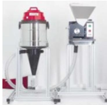
Fig. 3.2: b) Ciclón aspirador utilizado
