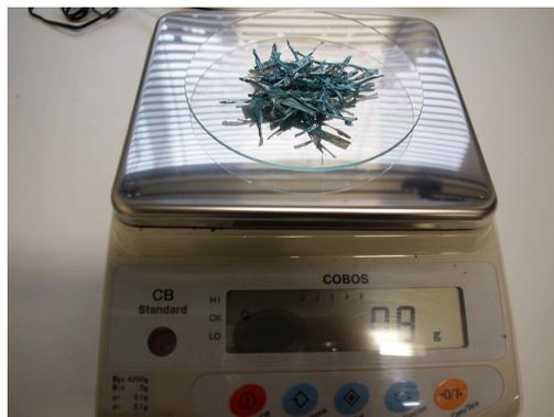
Fig. 3.17: Pesaje del material no conductor antes de triturar (bandeja nº 4)
