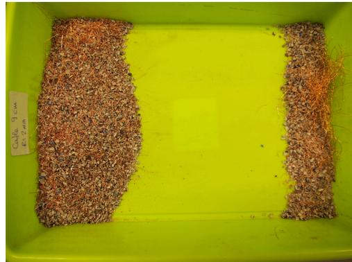
Fig. 3.92: Resultado de la muestra tras la trituración de cables de 9 cm
