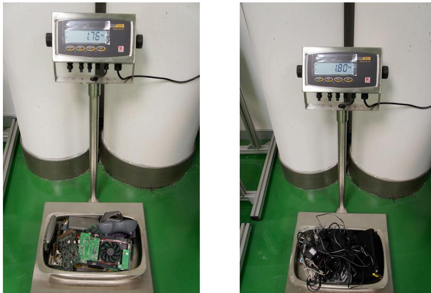
Fig. 3.9: Pesaje del material empleado para los ensayos
