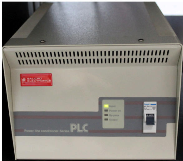
Figura 62. Estabilizador de corriente eléctrica para el láser.
