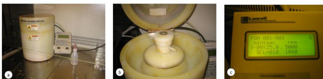
Figura 31. Proceso de spin-coating . a) Equipo de spin-coating . b) Colocación del sustrato. c) Programación de los datos de centrifugado.
