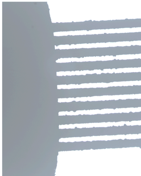
Figura 149. Fotografía tomada con un microscopio óptico, y un aumento 100x, de un microelectrodo de carbono embebido, fabricado con pasta de carbono sobre vidrio soda-lime.
