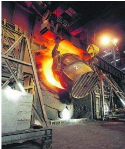
**Figura 2.2.** Carga de arrabio en el convertidor
