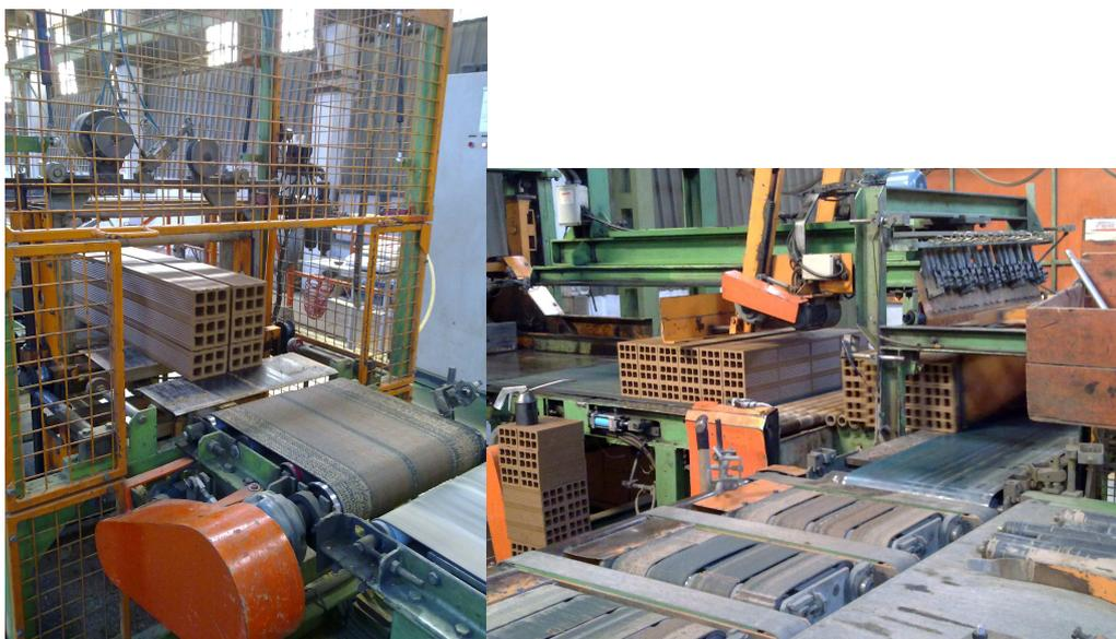
**Figura 7.22.** Proceso industrial fabricación ladrillos cerámicos
