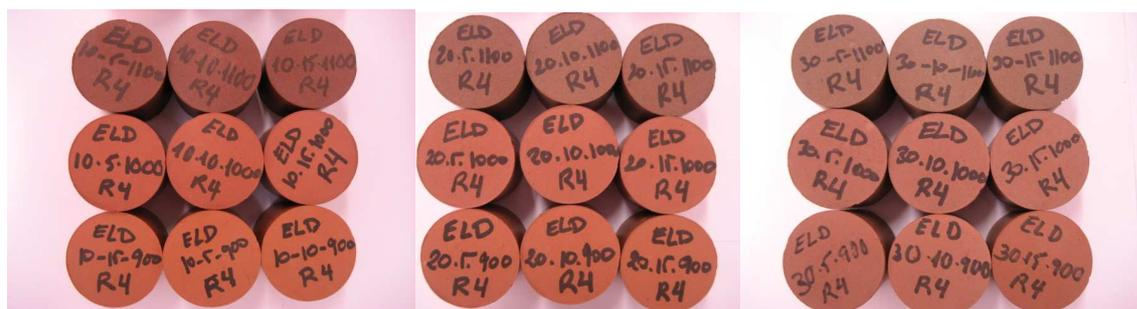
Figura 7.9. Color piezas cerámicas (izda.-dcha.: 10%, 20% y 30% escoria LD, abajo-arriba: 900°C, 1000°C y 1100°C)
