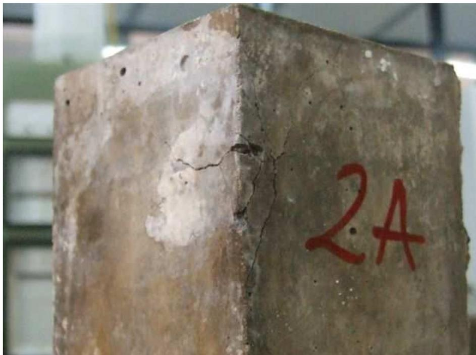
**Figura 6.11.** Grieta producida por expansión probeta 2A con escoria LD 0/10 mm
