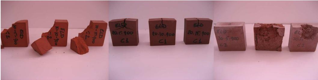
**Figura 7.15.** Piezas cerámicas tras ensayo heladicidad (izda.-dcha.: 10%, 20% y 30% escoria LD)
