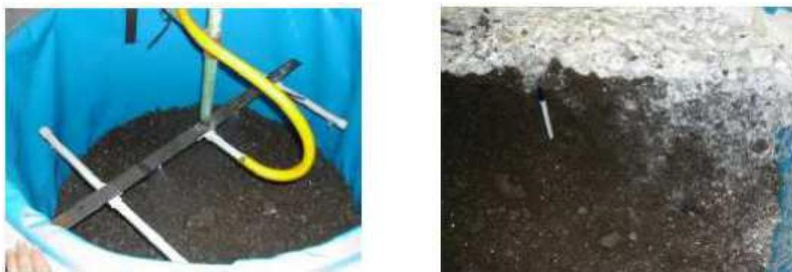
**Figura 4.1.** Sistema diseñado para la maduración natural (izda.) y detalle de la capa impermeable generada (dcha.).
