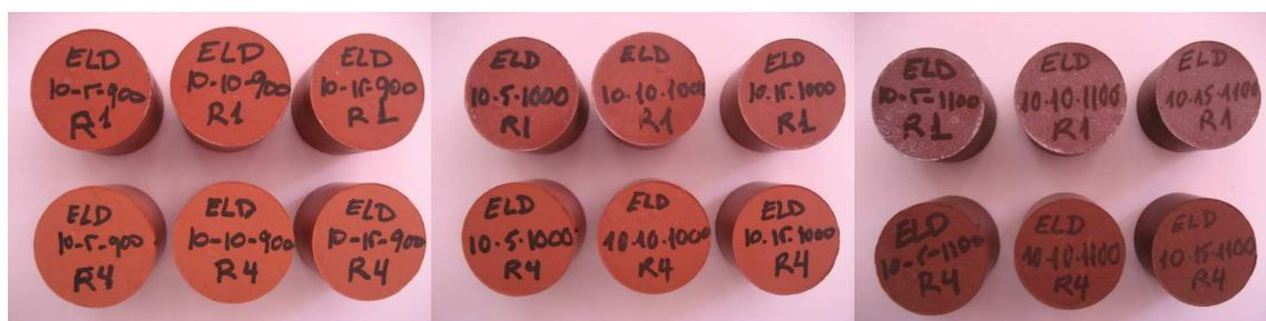
**Figura 7.19.** Eflorescencia piezas 10% escoria LD cocidas a 900°C, 1000°C y 1100°C (izda.-dcha.)
