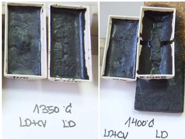
Figura 8.14. Pruebas de fusión escoria LD+CV a 1350°C - 1400°C
