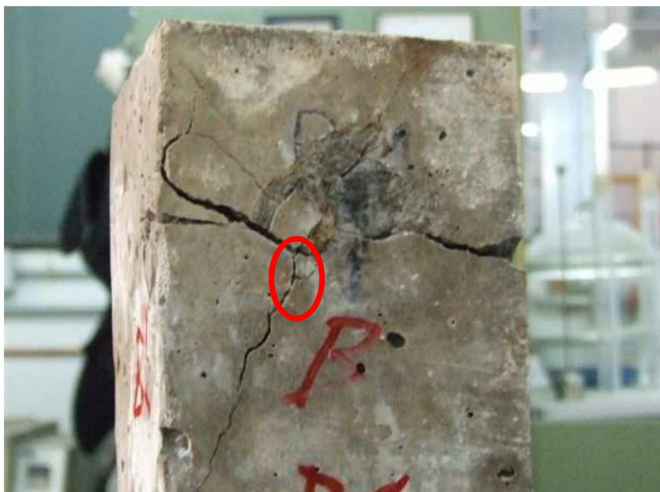
**Figura 6.12.** Grieta producida por expansión probeta B1 con escoria LD 10/19 mm
