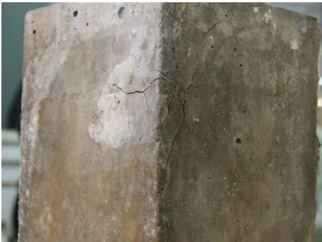
**Figura 6.13.** Grieta producida por expansión probeta C-2 con escoria LD 19/50 mm
