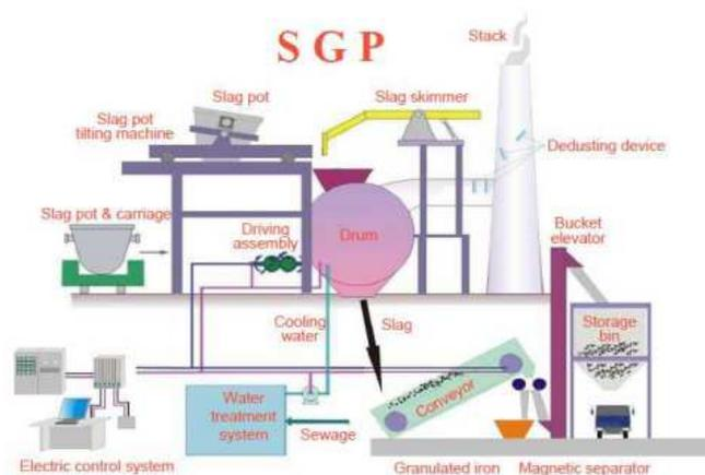
Figure 4.12. Proceso de granulación BSSF/SGP
