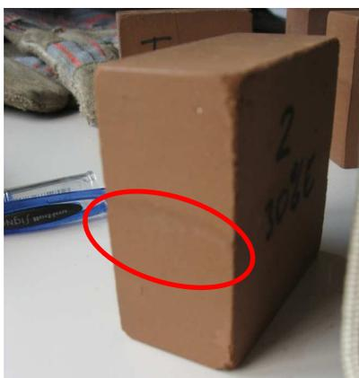
Figura 7.13. Marca de agua tras ensayo
