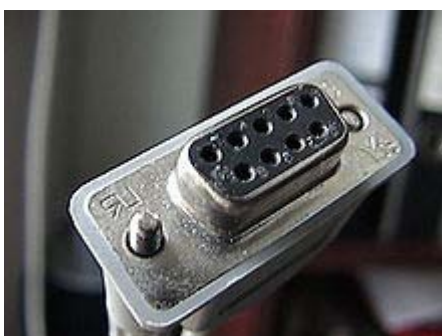
Conector RS-232 (DB-9 hembra).
