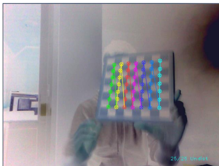
Proceso de calibración: Obtención de frames
