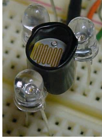
Ejemplo de fotoresistor con LEDs para detección de color
