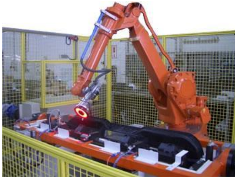
Brazo robótico industrial equipado con un sistema de visión artificial
