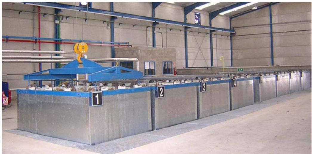
Figura 2.15 Proceso de Desestañado
