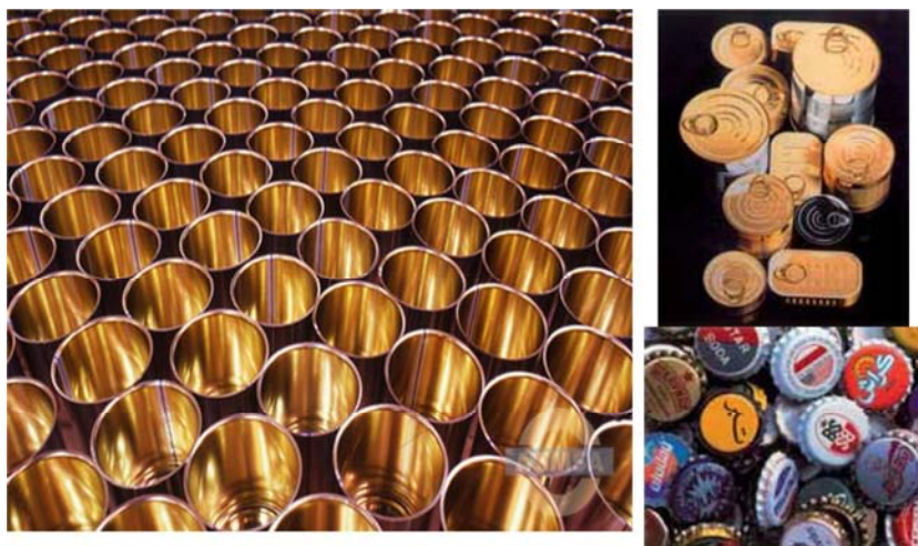
Figura 2.2 Envases de hojalata, envases de fácil apertura, tapones corona.
