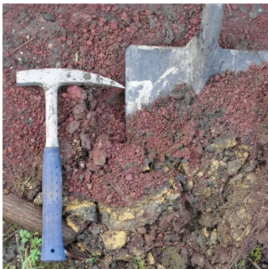
Fig.2.3.: Restos de cenizas e inquemados de pirita encontrados en la zona superficial de Nitrastur.
