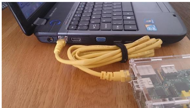
Ilustración 17. Conexión entre ordenador y Raspberry Pi
