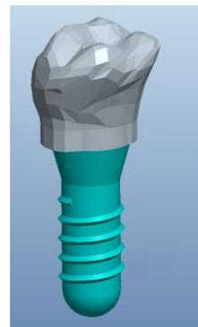
FIGURA 25. *Modelo de implante con atornillamiento transoclusal.*
