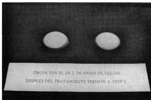
Fig. 1.—Pastillas de silicato de zirconio con un 20 % de óxido de calcio tratadas a 1.500°C durante dos horas.
