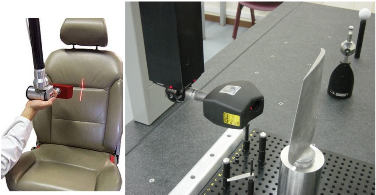
Fig. 6 – (izq.) Sensor de triangulación montado sobre un brazo de medición (Gscan Rx2, Romer©). (der.) Sensor Metris LC-50 montado sobre una MMC de puente (DEA Global),
