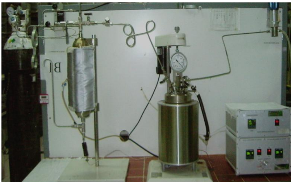
Figura 4. Reactor utilizado en la hidrólisis de proteínas en condiciones subcríticas.
