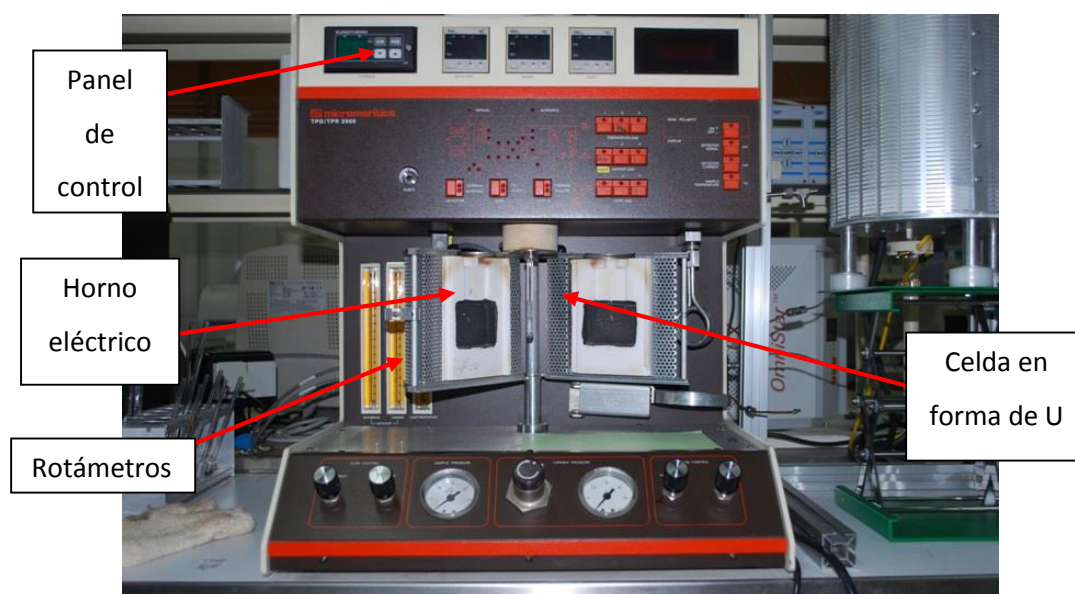
FIGURA 4.5: Equipo empleado para la realización de los experimentos de TPO
