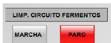
Ilustración 70: Botones de Marcha/Paro de Modo Limpieza Circuito de Inyección de Fermentos de Líneas de Cultivo y Siembra
