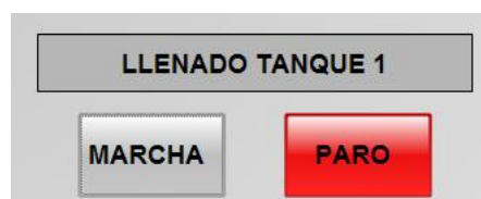
Ilustración 79: Botones de Marcha/Paro de Modo de Llenado de Tanque de Almacenamiento de Leche Pasteurizada
