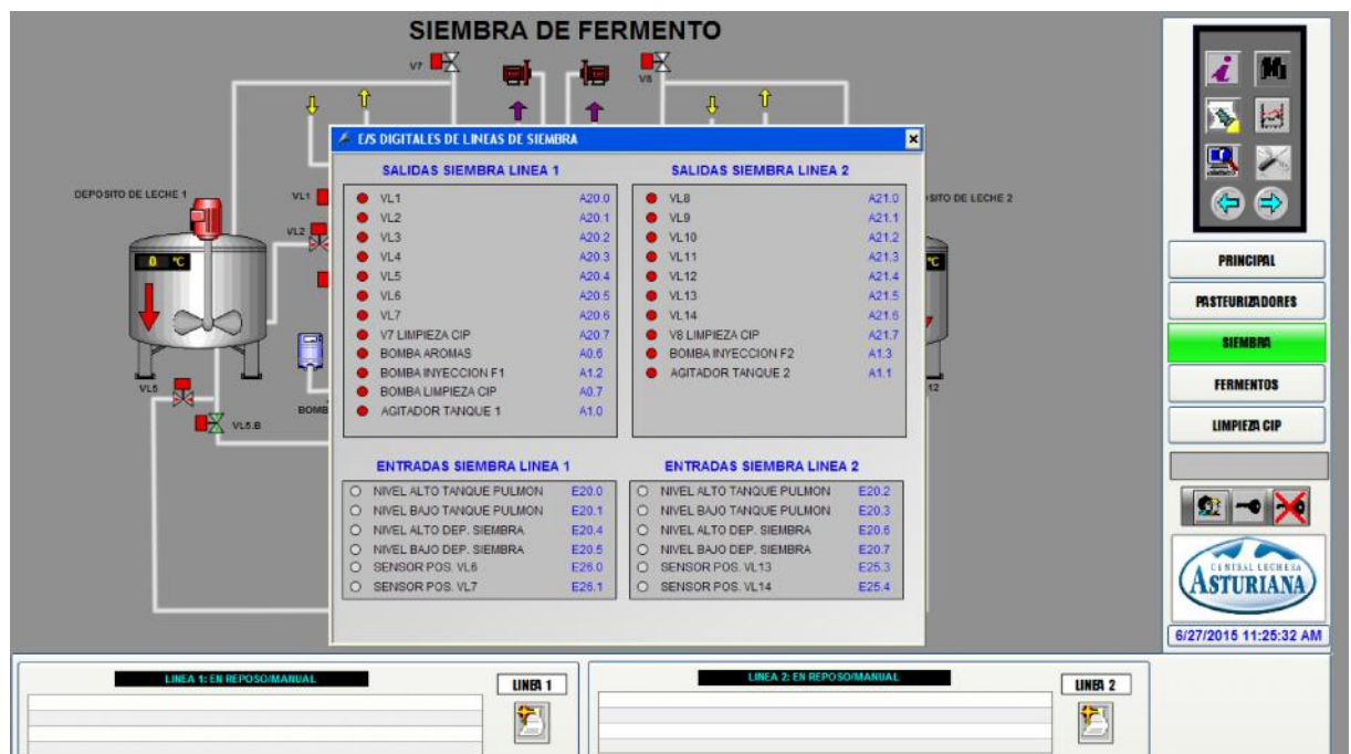
Ilustración 23: Ventana Desplegada para Visualización de Estado de Señales E/S Digitales en Líneas de Siembra
