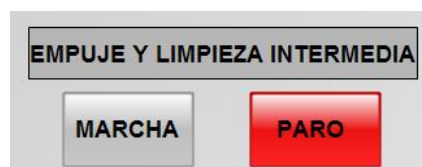
Ilustración 51: Botones de Marcha/Paro de Modo Empuje y Limpieza Intermedia de Línea de Pasteurización
