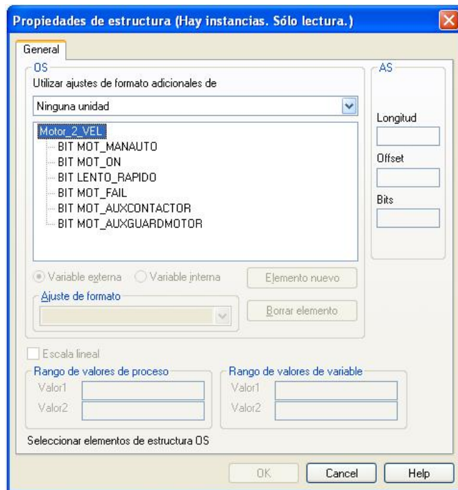
Ilustración 6: Estructura de Datos de Variable de Tipo Motor de 2 Velocidades
