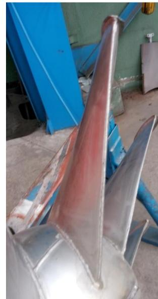
**Ilustración 2. Material de partida (izqda.) y álabes soldados y montado tras el proceso (dcha.)**
