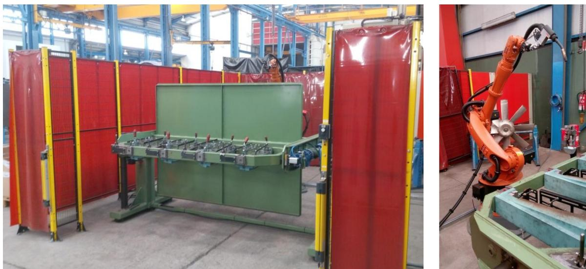
Ilustración 15. Célula de soldadura de Zitron (izqda.) y robot KUKA KR16 (dcha.)
