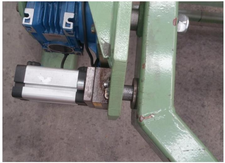
**Ilustración 23. Cilindro de fijación de la mesa global (izqda.) y de cada estación individual (dcha.)**
