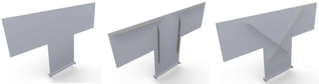
**Ilustración 67. Pantalla sin refuerzos (izqda.), con refuerzos perimetrales (centro) y en cruz (dcha.)**
