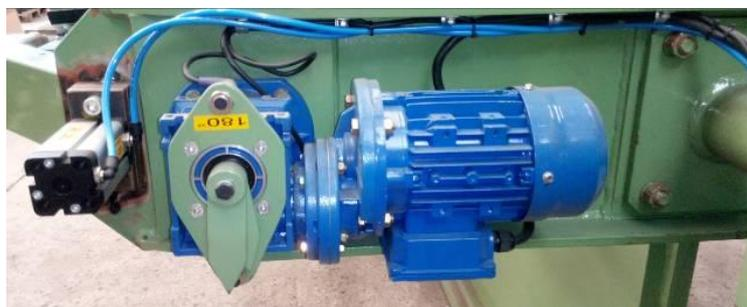
**Ilustración 25. Motorreductor de volteo general (izqda.) y de estación individual (dcha.)**
