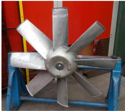
**Ilustración 1. Ventilador con los álabes soldados en el proceso**
