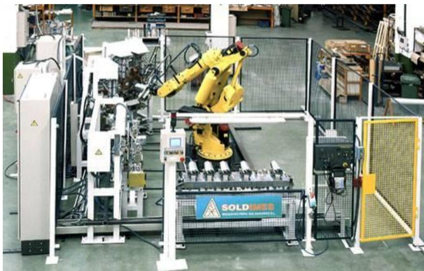
**Ilustración 3. Célula de manipulación y soldadura [soldimes]**
