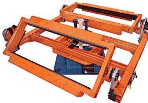
**Ilustración 9. Mesa de posicionamiento de tres ejes [Assemblymag]**
