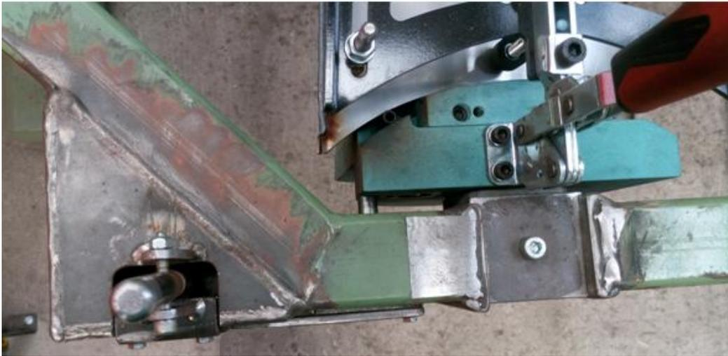
**Ilustración 98. Detalle del sistema de bloqueo por palanca**
