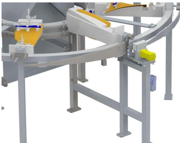
**Ilustración 78. Guía de puesta en posición de soldadura**
