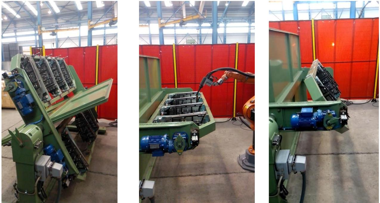
**Ilustración 17. Volteo de la mesa (izqda.), robot a punto de soldar (centro) y volteo de estación (dcha.)**
