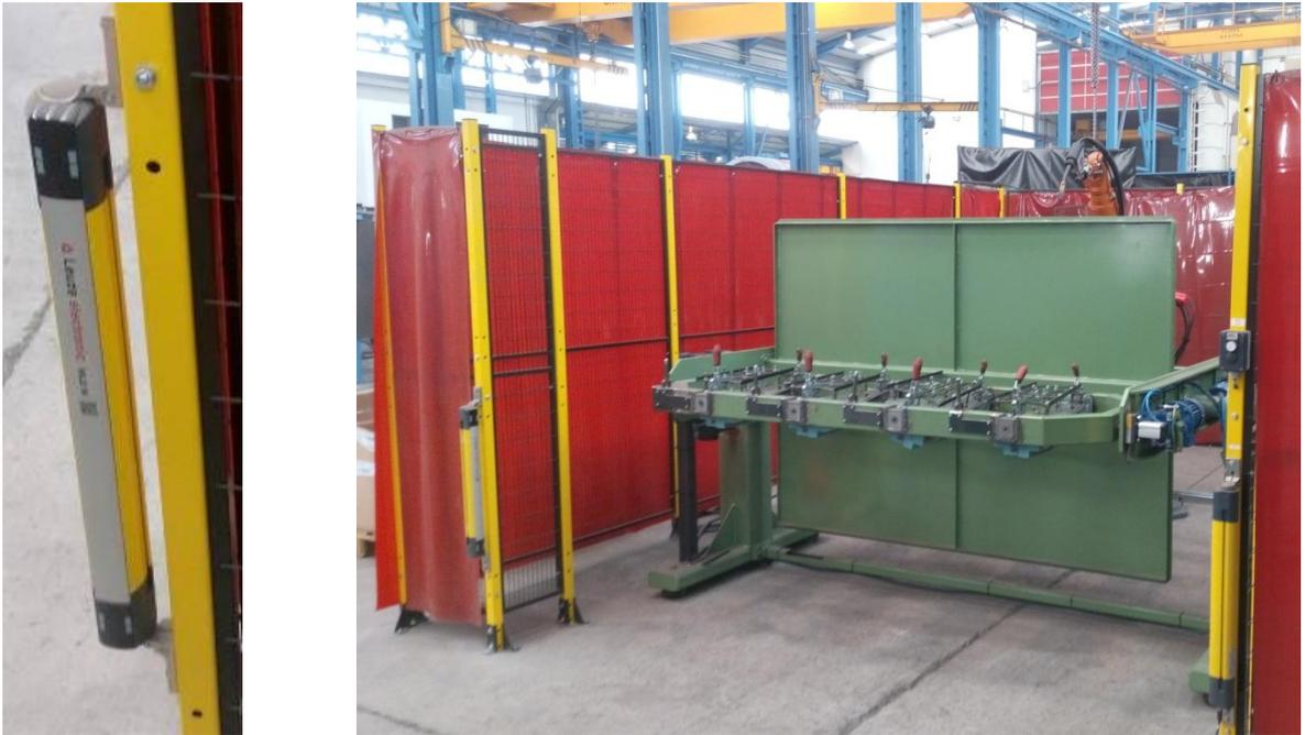
Ilustración 37. Detector de presencia (izqda.) y su emplazamiento en la célula (dcha.)
