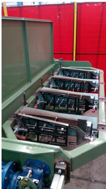
**Ilustración 16. Álabes preparados para ser soldados (izqda.) y estación de carga vacía (dcha.)**
