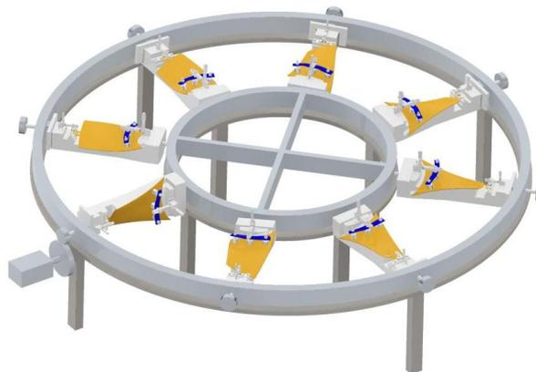
**Ilustración 51. Mesa circular plana con volteo mediante actuador auxiliar**
