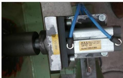
**Ilustración 26. Cilindro neumático de estación porta álabes**
