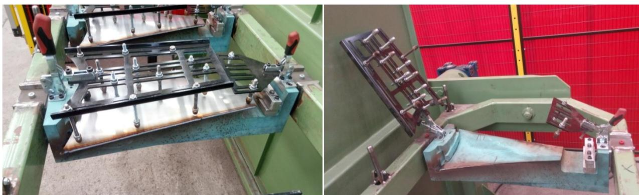
**Ilustración 97. Utillaje actualmente empleado cargado (izqda.) y descargado (dcha.)**
