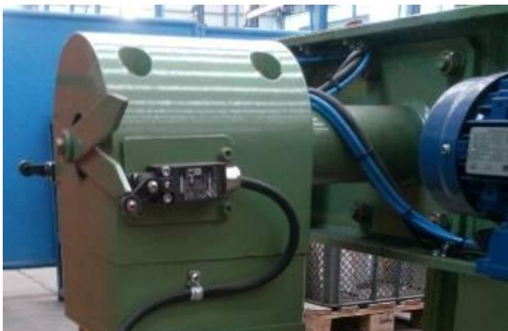
**Ilustración 28. Final de carrera de seguridad**
