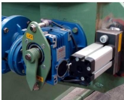
**Ilustración 29. Sensor inductivo de alcance de posición**
