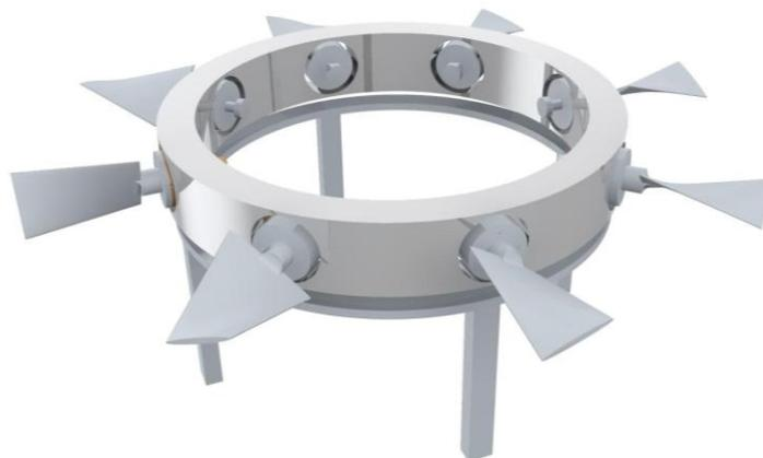
**Ilustración 52. Mesa tipo revólver con volteo por sistema mecánico**
