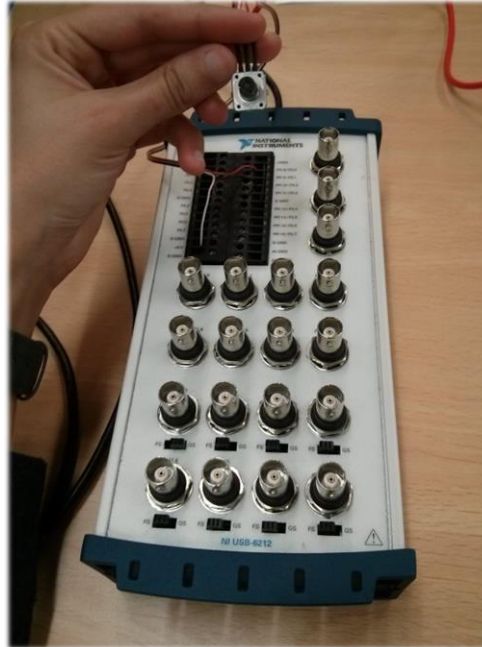
Figura 32: Encoder conectado a tarjeta adquisición
