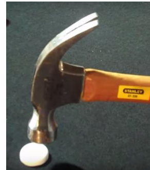
Figura 4.29: Demostración de la alta tenacidad de los Airloys.
