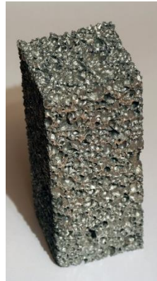
Figura 4.20: Ejemplo de pieza fabricada con espuma de aluminio.
