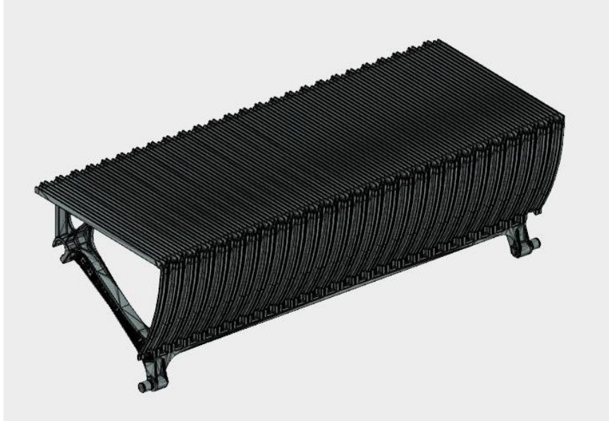
Figura 2.4: Modelo 3D del peldaño Velino.
