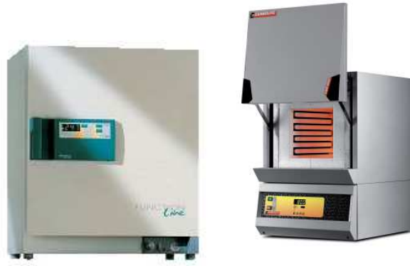
Imagen 4.5.- Estufa HERAEUS empleada para el cálculo de la humedad y Horno de cámara estándar CARBOLITE CWF 1100 utilizado para el ensayo de LOI
