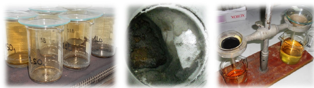
Imagen 4.12.- Determinación gravimétrica del contenido en \text{SiO}_2 presente en las Cenizas
