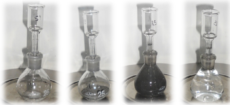
Imagen 4.11.- Cálculo de la Densidad Real ( d_r ), g/cm^3 , cálculo mediante picnómetro.
