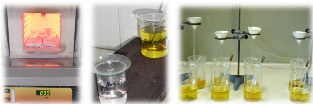
Imagen 4.8.- Determinación del contenido en sulfatos presentes en las Cenizas
