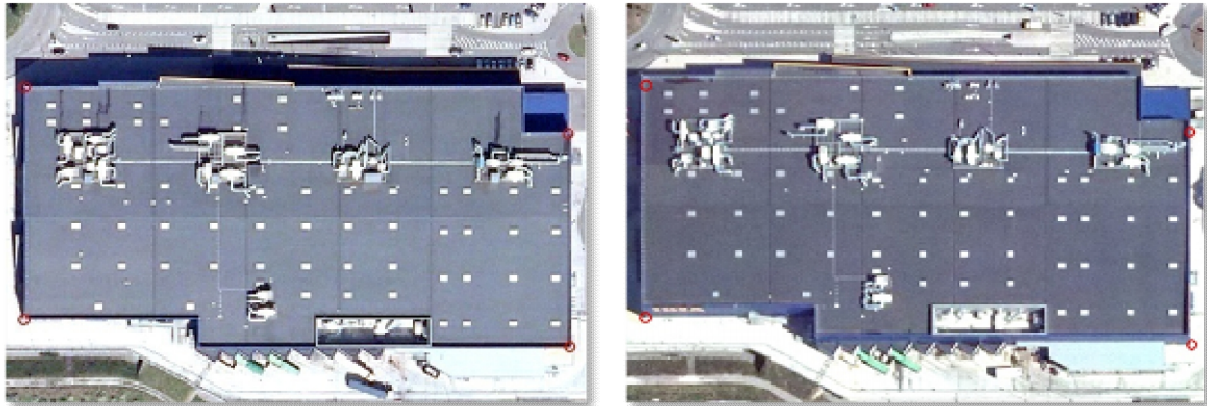
Figura 34: Distorsión en edificio IKEA. Izquierda Ortofotografía PNOA 2011. Derecha Ortofotografía PNOA 2006.
