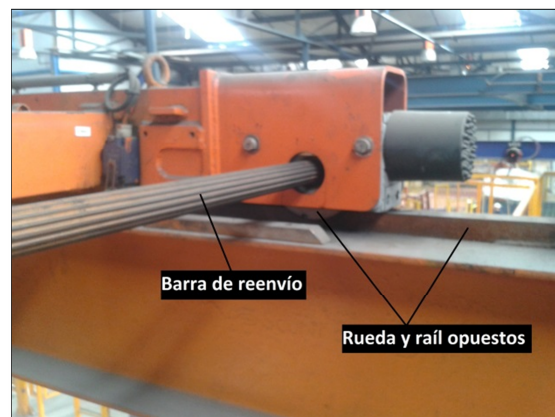
Fig. 14: Transmisión de potencia mediante barra de reenvío en el carro.
