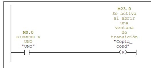
Fig. 61: Al final del FC7001 se resetea Copia_cond.
