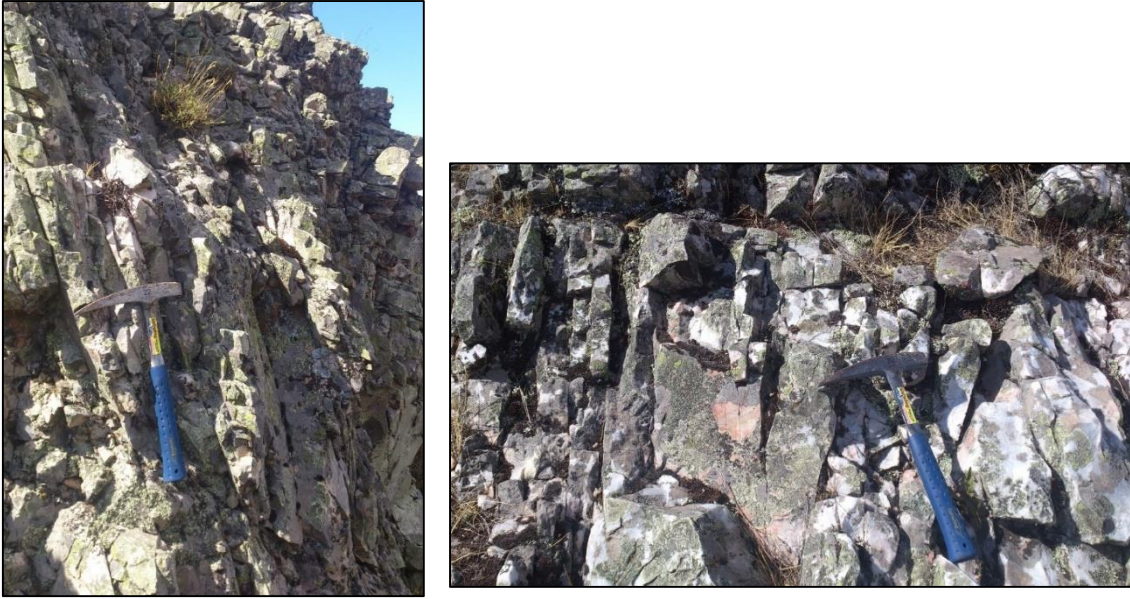
Figura 32.- Aspecto de campo de la unidad Q1 en distintas estaciones. En la imagen izquierda, el macizo aparece intensamente diaclasado. En la imagen derecha, el macizo aparece con menor intensidad de diaclasado, pudiendo observarse el espaciado de una de las familias de juntas.
