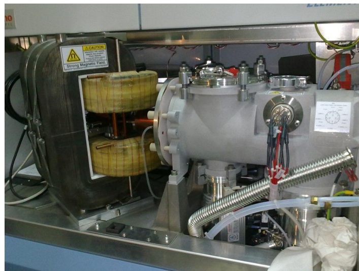
Figura 24: Sistema interno del ICP-MS de doble enfoque, ELEMENT 2.
