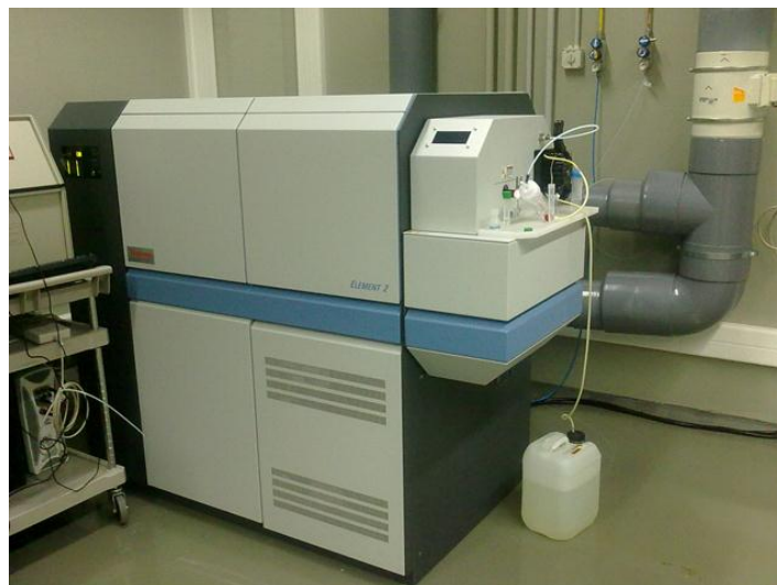
Figura 22: Imagen del ICP-MS de doble enfoque, ELEMENT 2, emplazado en los Servicios Científico Técnico de la Universidad de Oviedo.
