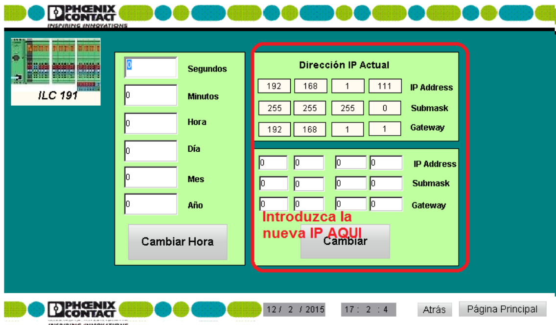
Ilustración 20 Cambiar Dirección IP controlador
