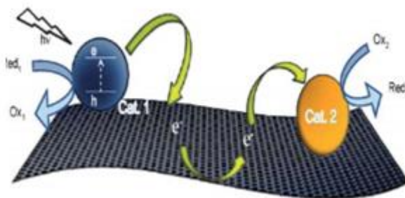
Figura 1.16. Esquema de un fotocatalizador de grafeno 54
