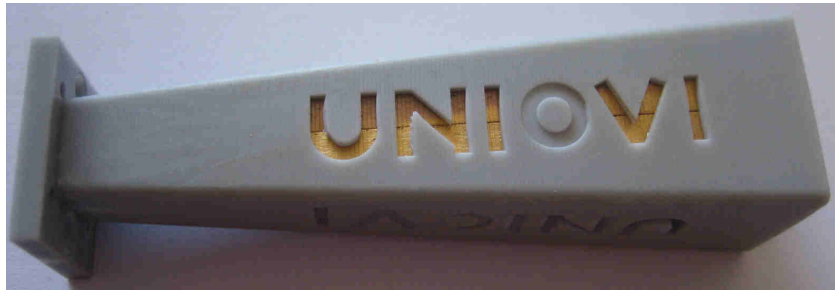
Figura 4.6: Fotografía del prototipo fabricado de la bocina diagonal de 70 mm de longitud.
