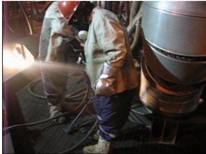
Figura A6.3: Captura de la muestra de fundido desde la torre de reacción
