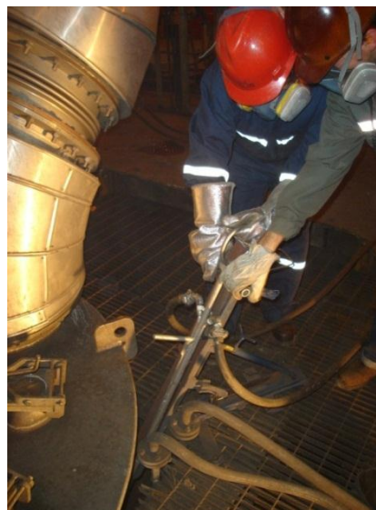
Figura 5.6: Lanza refrigerada sobre el atril en posición de captura de muestra.
