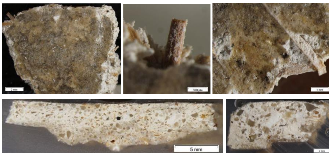
Figura 5.12.- Arriba: general y detalles de los fragmentos de madera presentes en la muestra mcCS2sup. Abajo: secciones transversales de las muestras mcCS2sup y mCS8 sup.
