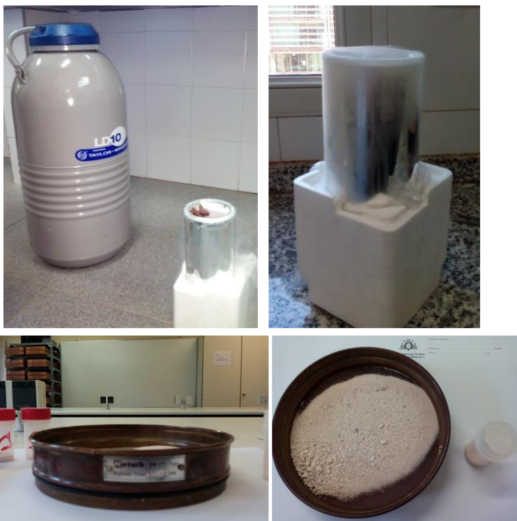
Figura 3.10.- Ensayo de choque térmico y cribado del mortero.
