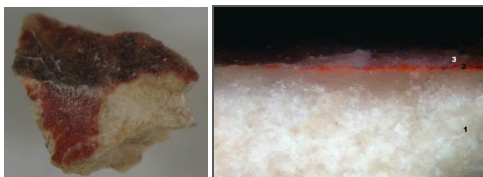
Figura 5.51.- Estratigrafía de la muestra EF7. Sobre la piedra de Laspra (1) se dispone una capa de color rojo (2) de 10 \mu\text{m} de espesor, elaborada a base de tierras rojas, albayalde, dolomita y yeso. Por encima de esta capa se detectan restos de otra capa de color blanquecino, con un espesor que varía entre 0 y 25 \mu\text{m} , elaborada a base de albayalde, yeso y silicatos.
