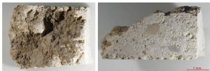
Figura 5.148.- Aspecto macroscópico del mortero M8/CV39 a la lupa binocular. En la imagen inferior se observan granos de cuarzo, fragmentos de carbón y algo de limolita. Los espacios vacíos son tipo poro.
