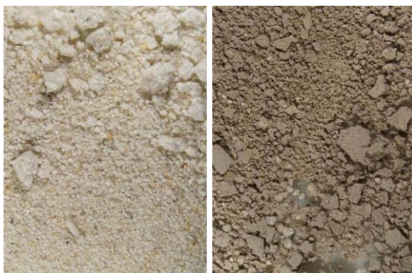
Figura 5.140.- Aspecto estereoscópico del residuo insoluble del mortero M6/CV37.
