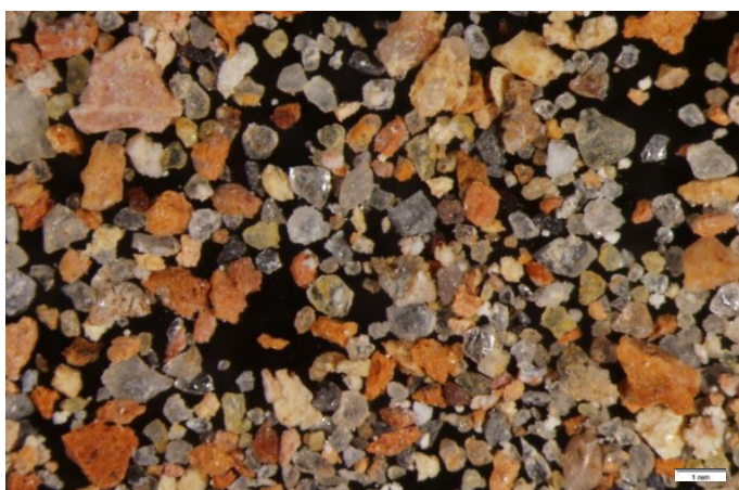
Figura 5.43.- Detalle del residuo insoluble de la matriz donde los fragmentos cerámicos y granos de cuarzo presentan tamaños superiores a 500 µm.
