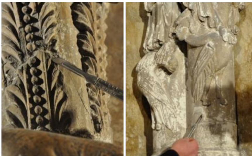
Figura 5.29.- Puntos de extracción de las muestras: EF15 (izqda.) y AF27 (dcha.) recogidas en dos ubicaciones diferentes: fuste de San Pablo y fuste de San Judas Tadeo, respectivamente.
