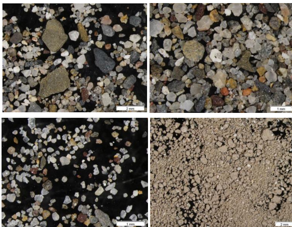
Figura 5.189.- Arriba: fracción gruesa del residuo insoluble de la muestra S.C.4./M.E.2 ue 1212. Se identifican fragmentos de roca, granos de cuarzo y algún cristal de microclina. El tamaño medio de los granos es de 500 \mu\text{m} . Abajo: detalles de la fracción fina del residuo insoluble, constituida mayoritariamente por granos de cuarzo y arcillas.
