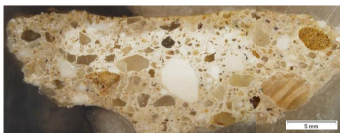
Figura 5.2.- Aspecto macroscópico, a la lupa binocular del mortero de juntas (muestra mCS12), en superficie externa e interna (arriba) y en sección transversal (abajo). En la imagen inferior se aprecia la textura del mortero constituida por una serie de áridos de naturaleza silícea y carbonatada, inmersos en una matriz, aparentemente carbonatada.
