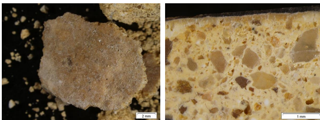
Figura 6.53.- Sección transversal del mortero tipo V con el recubrimiento original pictórico del mortero de reconstrucción del ábside.
