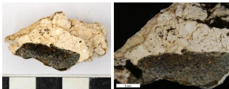
Figura 5.205.- Aspecto macroscópico del mortero S.C.8/(M.N.2)/ue 1111. Los áridos presentes en el mortero aparecen inmersos en una matriz blanquecina. A esta escala destaca un fragmento de arenisca, de tamaño centimétrico.
