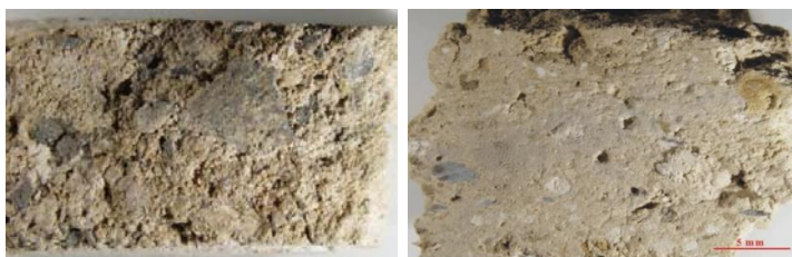
Figura 5.162.- Aspecto macroscópico, a la lupa binocular, del mortero M11/CV42 en superficie y en corte transversal. A esta escala se identifican granos de cuarzo, algún fragmento de carbón, algo de limolita y nódulos de cal.
