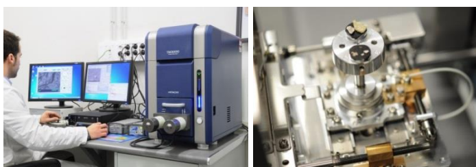
Figura 3.2.- Microscopio electrónico de barrido con análisis químico elemental por energía dispersiva de rayos X.
