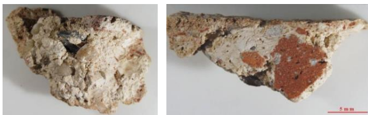
Figura 5.144.- Aspecto macroscópico del mortero M7/CV38, a la lupa binocular. Se identifican granos de cuarzo, fragmentos cerámicos y algún fragmento de carbón. Los espacios vacíos, tipo poro, son abundantes.
