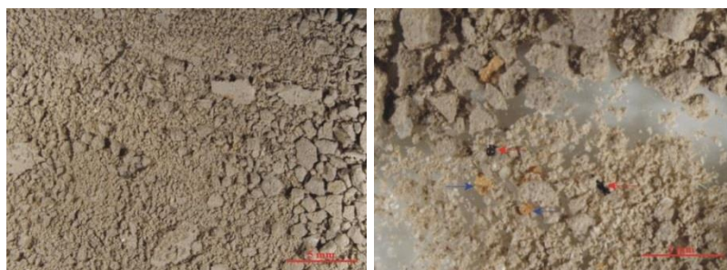
Figura 5.153.- Detalles a la lupa binocular de la fracción fina del residuo insoluble del mortero M9/CV40. En la imagen inferior, además de cuarzo y arcillas, se identifican granos de carbón (flechas rojas) y fragmentos cerámicos (flechas azules).
