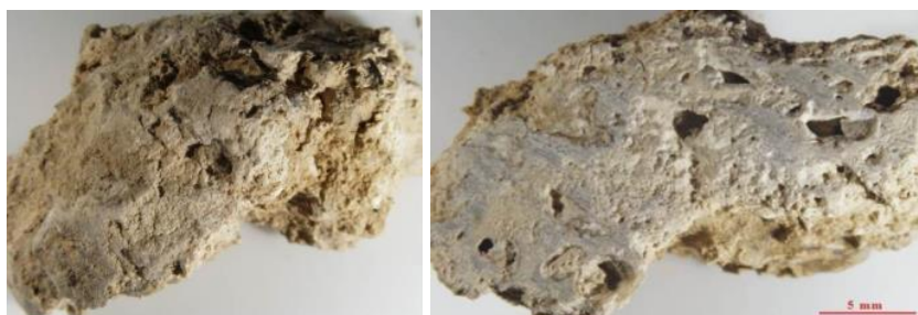
Figura 5.157.- Aspecto macroscópico de la muestra M10/CV41, a la lupa binocular, en superficie y en corte transversal. A esta escala únicamente se identifican granos de cuarzo, aglutinados en una matriz carbonatada. Los espacios vacíos tipo poro presentan elevados radios de acceso.
