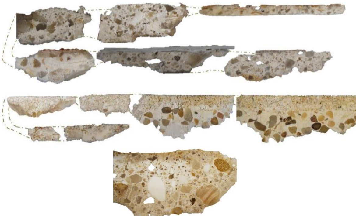
Figura 6.7.- Detalle de las muestras de los revoco históricos analizados, en sección transversal. La secuencia superior corresponde al revoco románico, la intermedia al altomedieval y la inferior al mortero de juntas que traba la mampostería de fábrica de la Cámara Santa.
