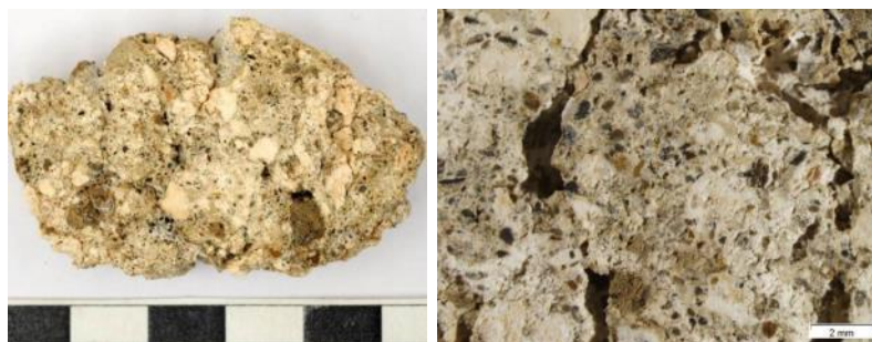
Figura 5.192.- Aspecto macroscópico y estereoscópico del mortero S.C.5/(M.E.3)/ue 1204.. A esta escala se identifican abundantes áridos de diversa naturaleza y espacios vacíos tipo poro con radios de acceso de gran tamaño.
