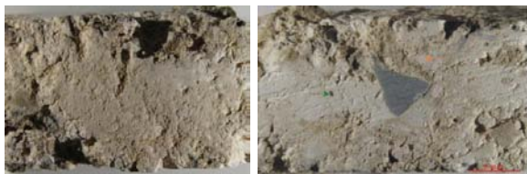
Figura 4.165.- Aspecto macroscópico del mortero M12/CV43 en superficie y en sección transversal. En las imágenes se observan granos de cuarzo, fragmentos de carbón y nódulos de cal.
