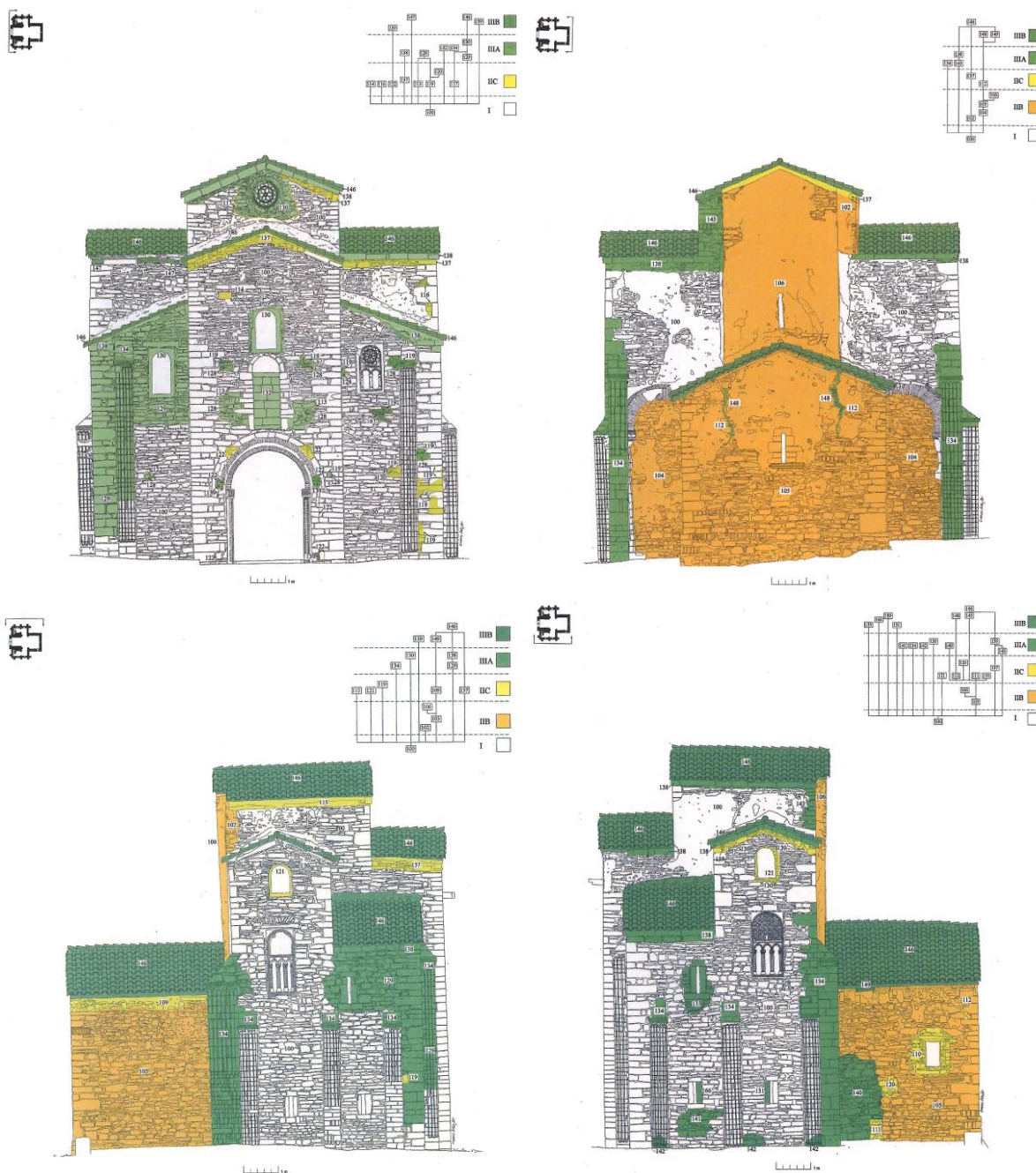
Figura 4.36.- Arriba y abajo, a izquierda y derecha: fachadas oeste, este, norte y sur, respectivamente, de la iglesia de San Miguel de Lillo (imágenes tomada de Caballero et al. , 2006). La ruina y restauración del edificio ocurrió con cierta inmediatez a su construcción. La fase IIA corresponde a la construcción de la cabecera, producida la ruina y la fase IIB a la construcción de la cabecera actual, el ábside de planta rectangular y el cierre de las naves laterales. La fase III recoge distintas restauraciones contemporáneas.
