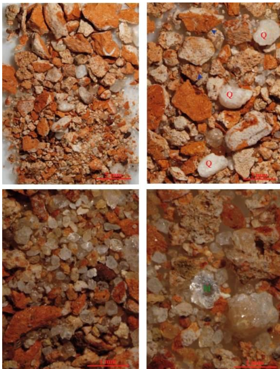
Figura 5.132.- Aspecto a la lupa binocular de la fracción gruesa y fina del residuo insoluble del mortero M4/CV35. En las imágenes se identifican granos de cuarzo (Q), fragmentos cerámicos (flechas azules) y algún grano de micas del tipo moscovita (M).
