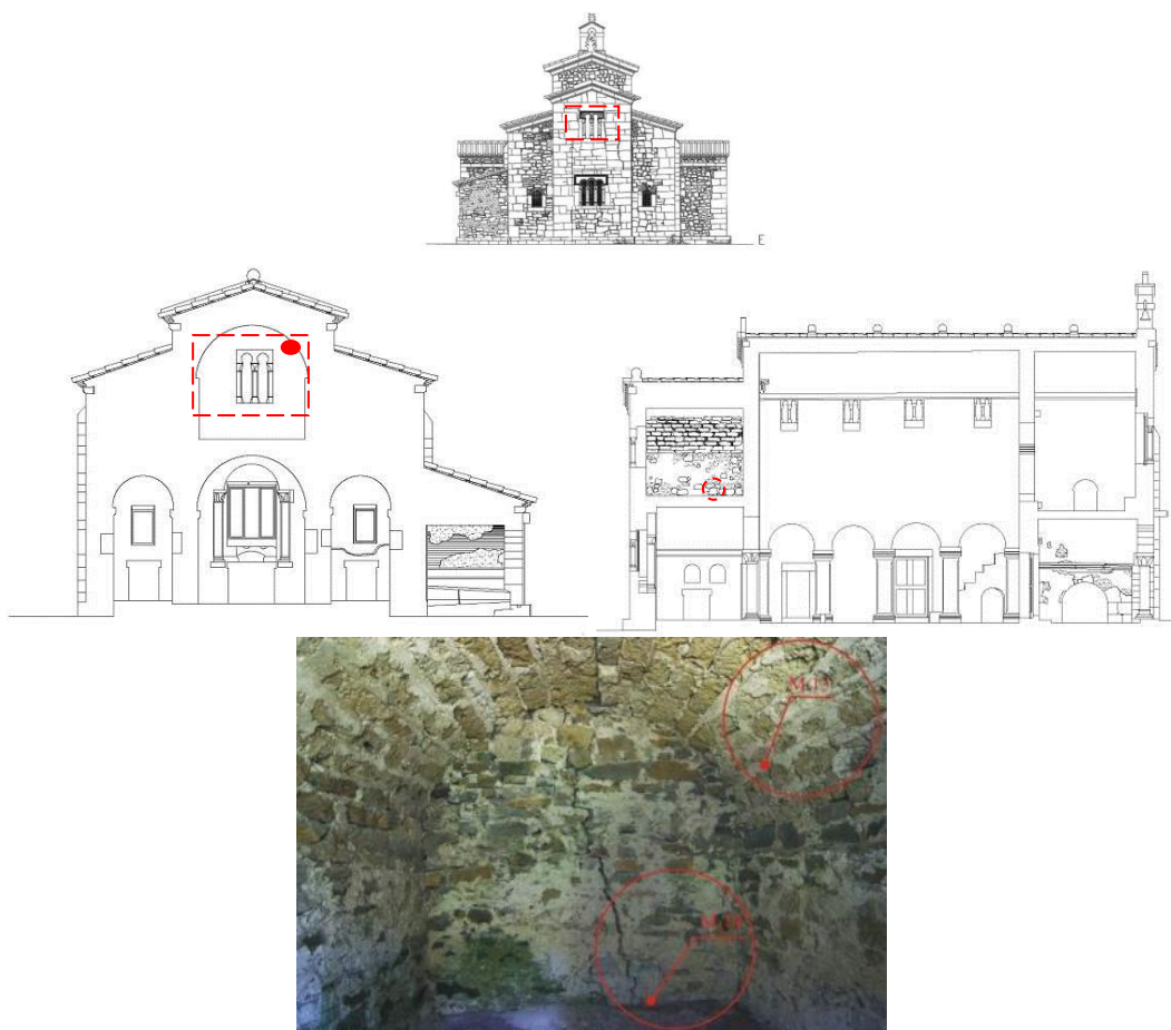
Figura 5.168.- Localización y aspecto «in situ» de la muestra de mortero M13/CV44.
