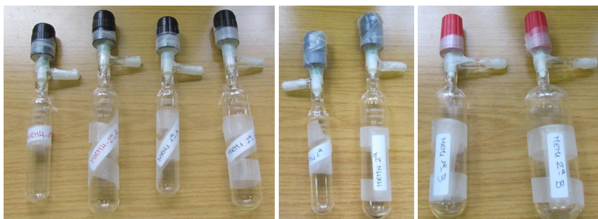
Figura 5.322.- Aspecto macroscópico de los viales de CO 2 , capturado de forma secuenciada, durante la hidrólisis de la muestra MRM.
