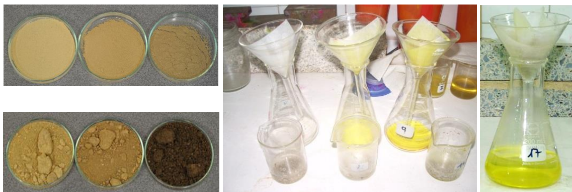
Figura 3.4.- Ensayo de ataque químico, con ácido clorhídrico diluido al 15%.
