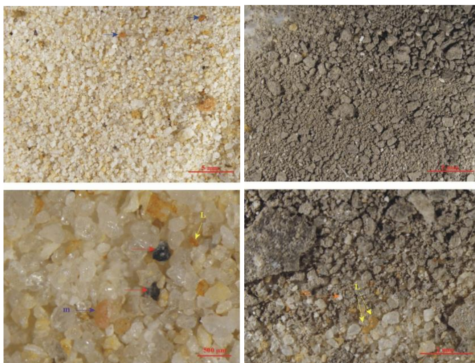
Figura 5.149.- Izquierda: aspecto a la lupa binocular de la fracción gruesa del residuo insoluble del mortero M8/CV39. En las imágenes se observan abundantes granos de cuarzo, además de fragmentos cerámicos (flechas azules), granos de carbón (flechas rojas), fragmentos de limolita (L) y microclina (m). Derecha: detalles de la fracción fina del residuo insoluble del mortero. En las imágenes inferior se identifican granos de cuarzo, reubiertos mayoritariamente por arcillas, limolita (L) y algún nódulo de cal (Nc).
