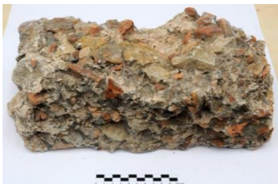
Figura 5.39.- Aspecto de la muestra del suelo de la Cámara Santa. Destaca el tamaño centimétrico de los áridos que conforman este mortero.
