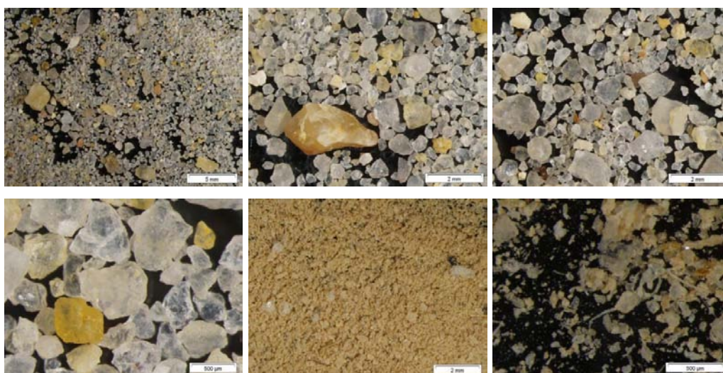
Figura 5.256.- Aspecto del residuo insoluble HLNLE1.2, de la fase inferior de la muestra HLNLE1, del mortero tipo IV a la lupa binocular. En las imágenes se observa la fracción gruesa y fina del residuo.
