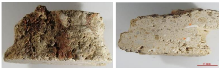
Figura 5.123.- Aspecto del mortero M2/CV33 en sección transversal, a la lupa binocular. A esta escala se identifican granos de cuarzo, nódulos de cal, cristales de microclina y minerales arcillosos. Los espacios vacíos, tipo poro aparecen heterogéneamente distribuidos en las zonas más externas.
