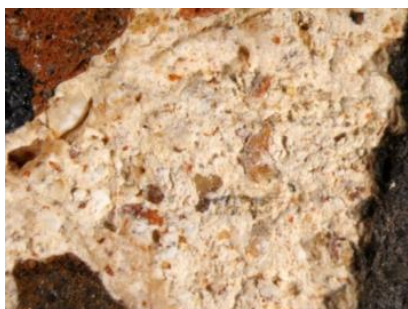
Figura 5.41.- Detalle a la lupa binocular de la fase aglomerante del hormigón del solado de la Cámara Santa. La matriz carbonatada aglutina áridos con tamaños inferiores a 1 mm.
