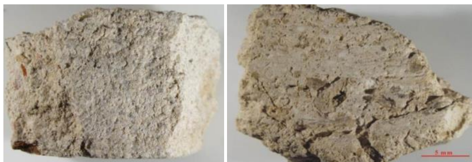
Figura 5.177.- Aspecto macroscópico del mortero M15/CV46 en superficie y sección transversal. A esta escala se identifican granos de cuarzo, fragmentos de carbón, limolita y nódulos de cal
