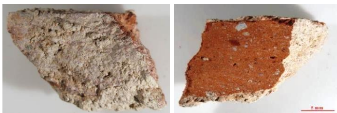
Figura 4.128.- Aspecto general del mortero M3/CV34, a la lupa binocular. Dentro de la matriz arcillosa del fragmento cerámico se identifican granos de cuarzo.
