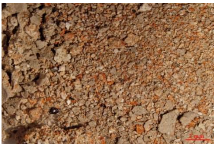
Figura 5.133.- Detalles, a la lupa binocular, de la fracción fina del residuo insoluble del mortero M4/CV35. En la imagen se identifican granos de carbón y nódulos de cal, además de fragmentos cerámicos y minerales arcillosos.
