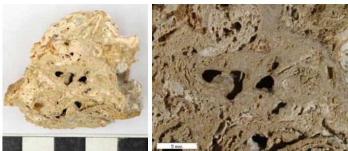
Figura 5.213.- Aspecto macroscópico y estereoscópico del mortero S.C.10./(M.N.4)/ue 1109. Su aspecto recuerda al de una toba calcárea, originada por precipitación de carbonato cálcico disuelto en agua en forma de finas capas.
