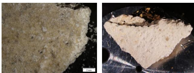
Figura 6.40.- Aspecto general y detalle de la escayola incorporada por Menéndez Pidal en la intervención de los años 1954, 1961 y 1965.
