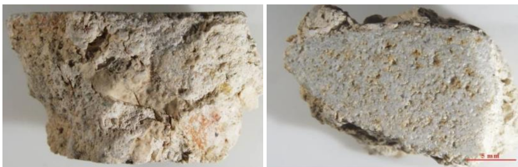
Figura 5.139.- Aspecto estereoscópico del mortero M6/CV37. A esta escala de observación se identifican abundantes granos de cuarzo, granos de limolita y algún fragmento de carbón. Los espacios vacíos en este mortero son de tipo poro.
