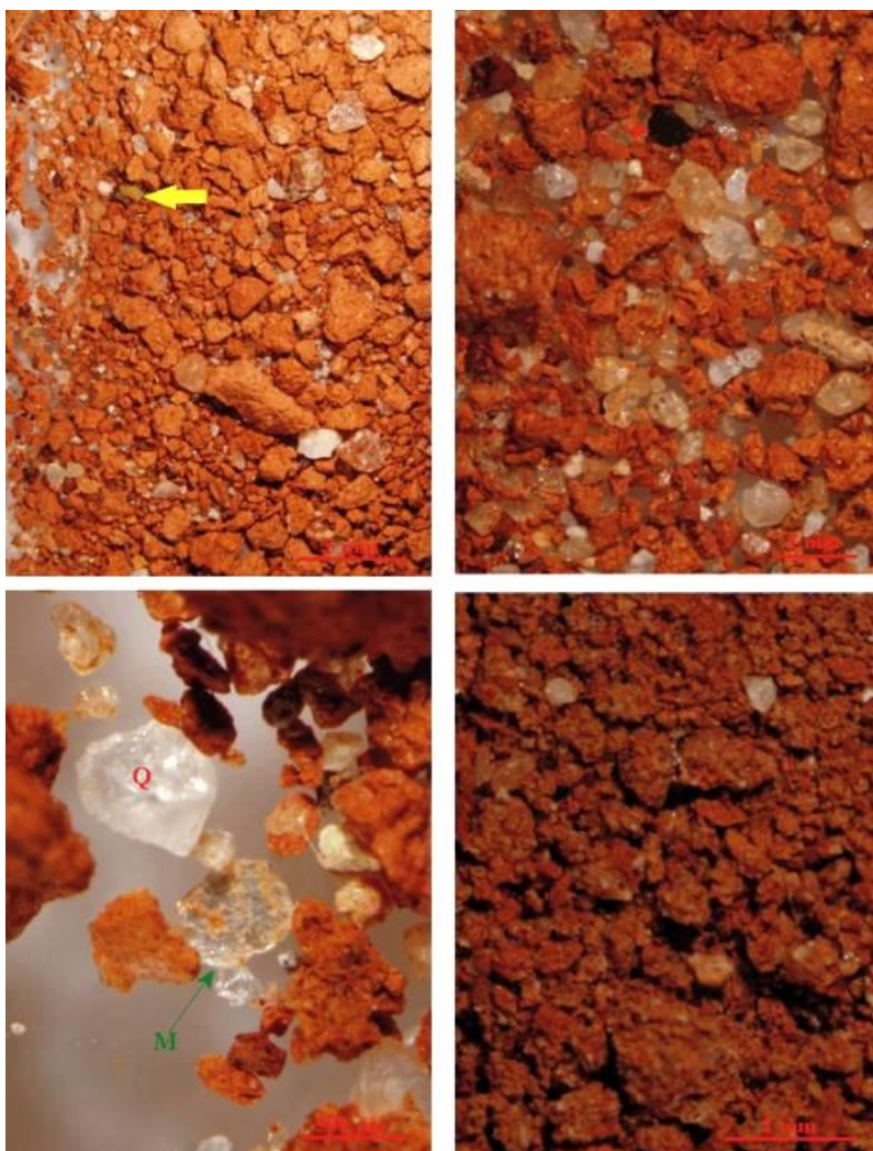
Figura 5.129.- Detalles a la lupa binocular del residuo insoluble del mortero M3/CV34, después del ataque químico. En las micrografías se observa que la fracción gruesa está constituida mayoritariamente por fragmentos cerámicos con algo de limolita (flecha amarilla) y pequeños fragmentos de carbón (flechas rojas). Las imágenes inferiores muestran detalles de granos de moscovita (M) y cuarzo (Q).
