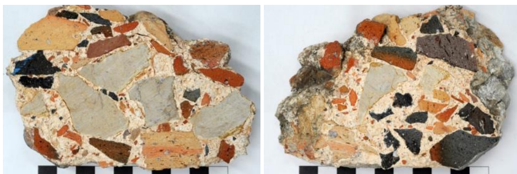
Figura 5.40.- Aspecto macroscópico de una sección transversal del hormigón. Está constituido por áridos de tamaño centimétrico, principalmente fragmentos cerámicos de colores rosados, rojos y negruzcos, y fragmentos de caliza de colores grisáceos, unidos por un conglomerante de tonalidades rosadas.
