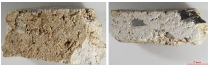
Figura 5.119.- Aspecto macroscópico del mortero M1/CV32 a la lupa binocular en superficie y sección transversal. En las micrografías se identifican granos de cuarzo (Q), fragmentos de rocas; caliza de color gris, limolita de color ocre y espacios vacíos tipo poro.
