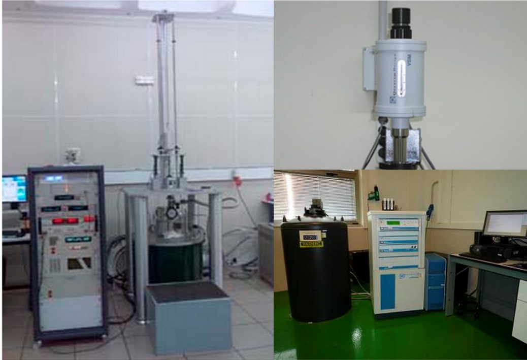
Figura 2.10. Izquierda: sistema de medidas magnéticas de la UPV/EU. Derecha: PPMS-14 T de los Servicios Científico-Técnicos de la Universidad de Oviedo (abajo) con el módulo de VSM (arriba).
