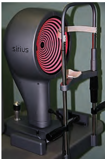
Figura 16: Sistema de topografía y aberrometría Sirius (Costruzione Strumenti Oftalmici).
