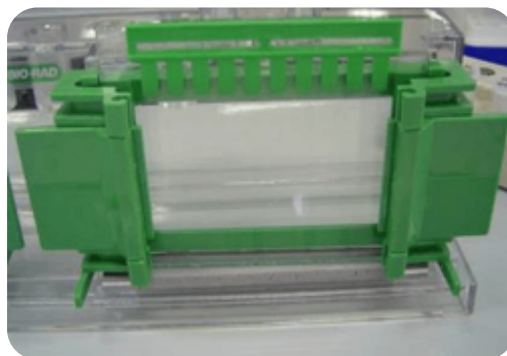
Figura 6. Cassette para preparación de geles de Bio-Rad.
