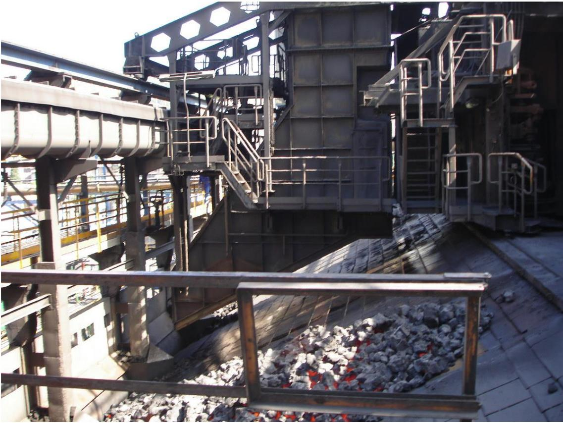
*Ilustración 5- Rampa de apagado*
