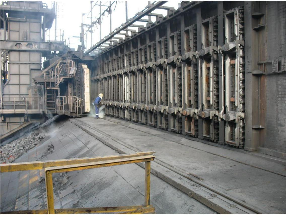
*Ilustración 4- Hornos donde se calienta el coque hasta temperaturas superiores a 1000°C*
