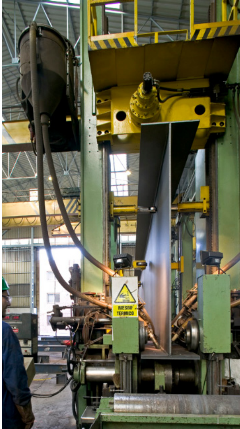
Figura 3. Entrada de la pieza y arcos de soldadura
