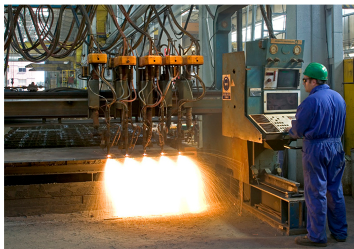
Figura 36. Oxicorte con múltiples sopletes para corte simultaneo
