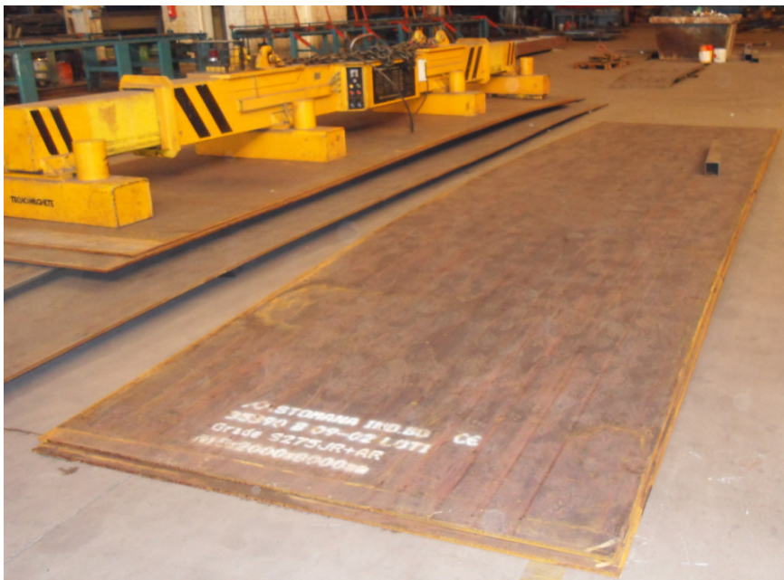
Figura 23. Chapa plana para fabricación de viga armada
