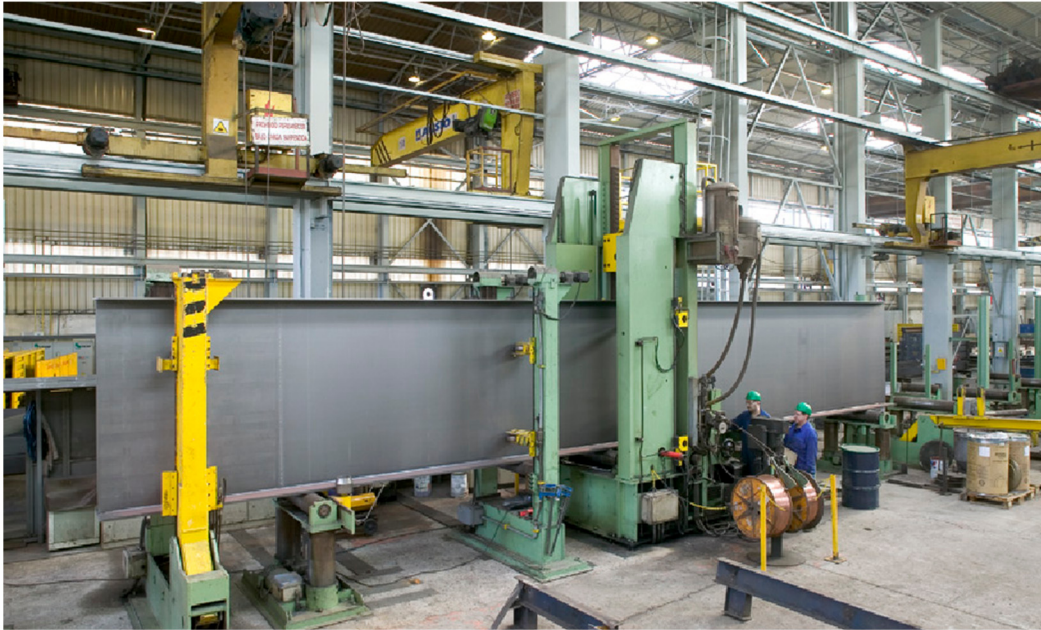
Figura 40. Máquina de armado de viga armada
