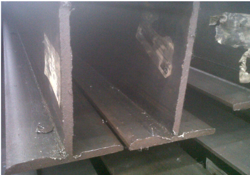
Figura 4. Dobles T realizadas con soldadura por fusión sin aporte de material
