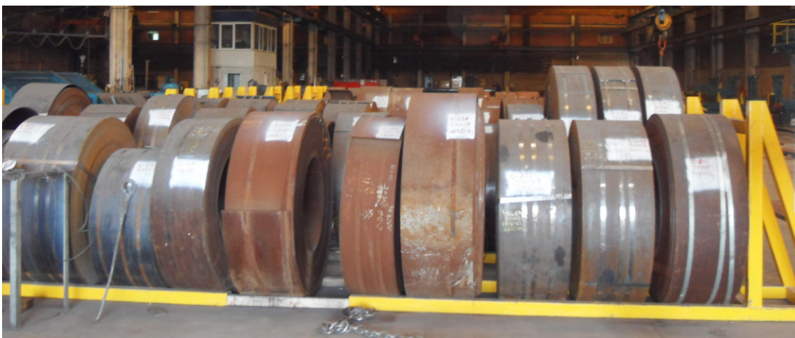
Figura 24. Bobina para fabricación de viga armada
