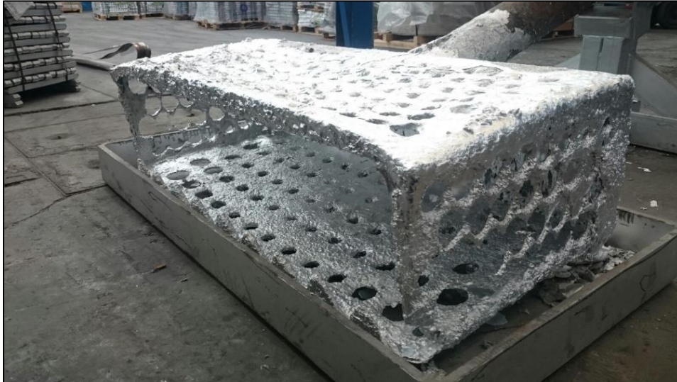
Figura 2.2 – Brazo de acero fabricado en acero S275JR tras 72 horas de trabajo.
