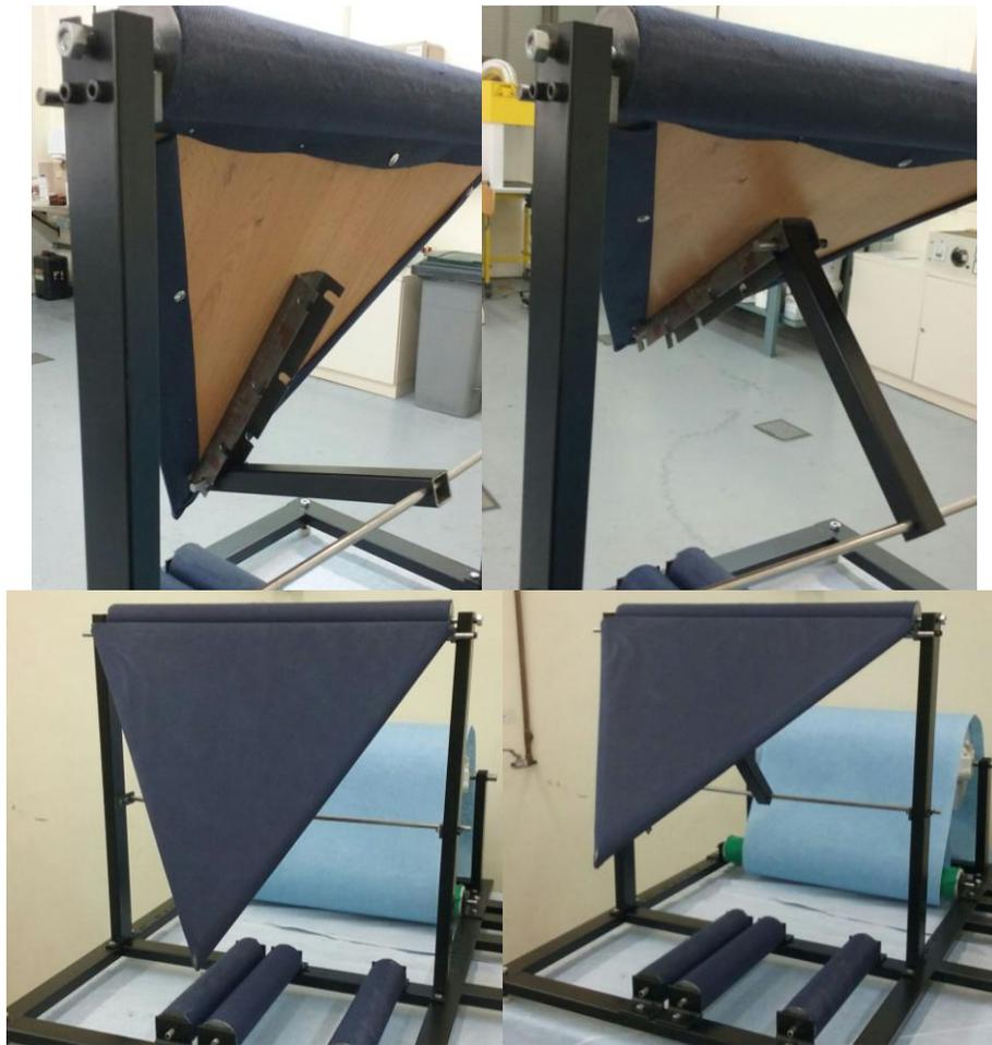
Figura 1.14. Sistema de inclinación del triángulo
