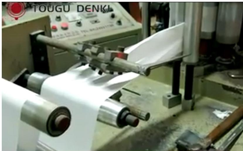
Figura 1.6. Sistema con elemento intermedio: Máquina dobladora de pañuelos de papel
