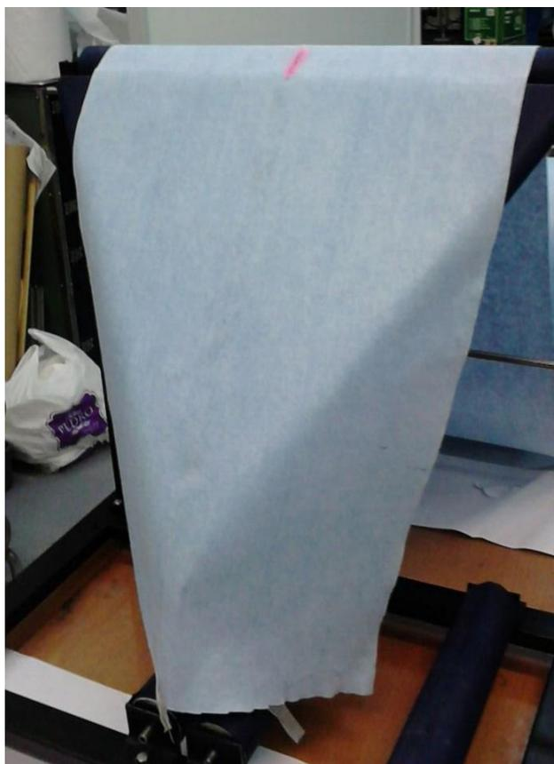
Figura 1.18. Comprobación del centrado de la tela. Entrada del triángulo
