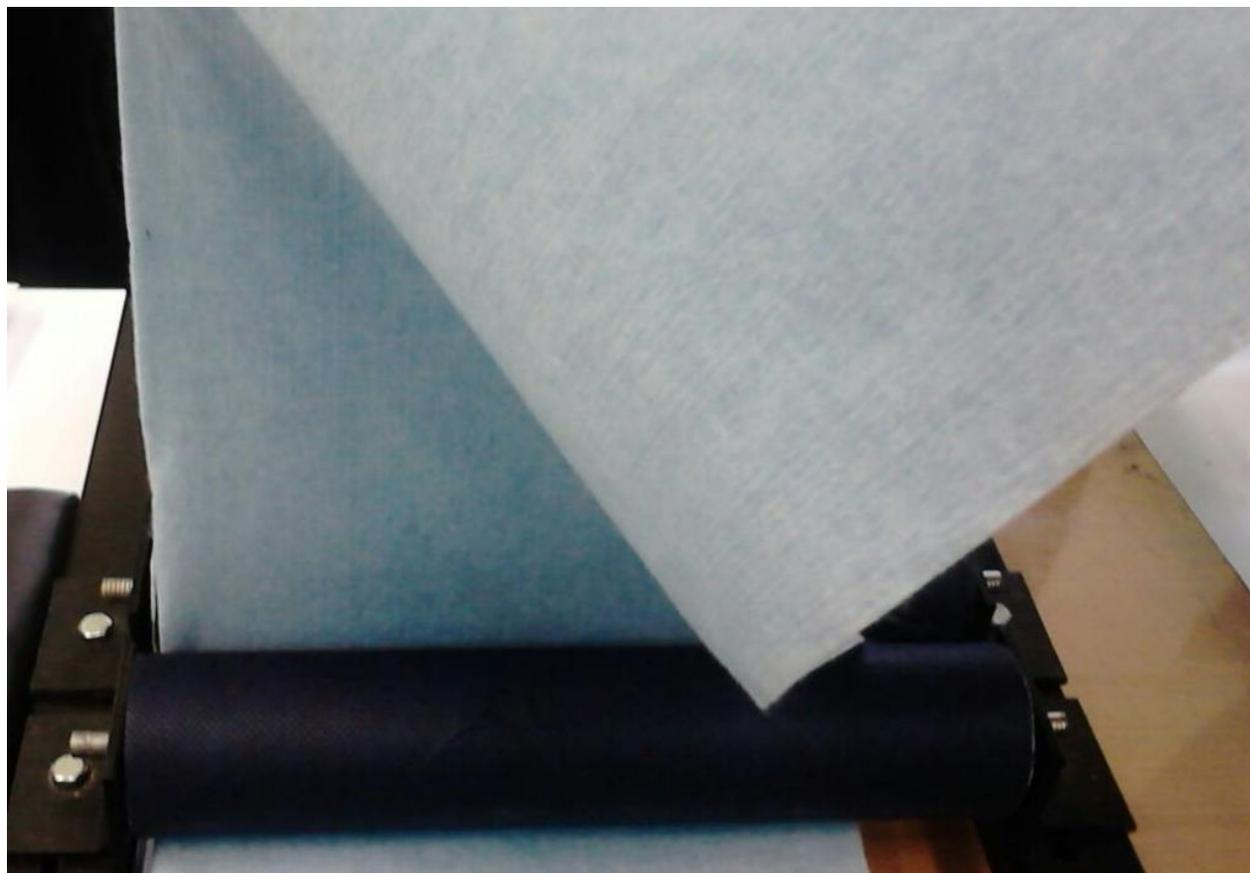
Figura 1.29. La tela entra sin tensar en los rodillos. Prueba 9
