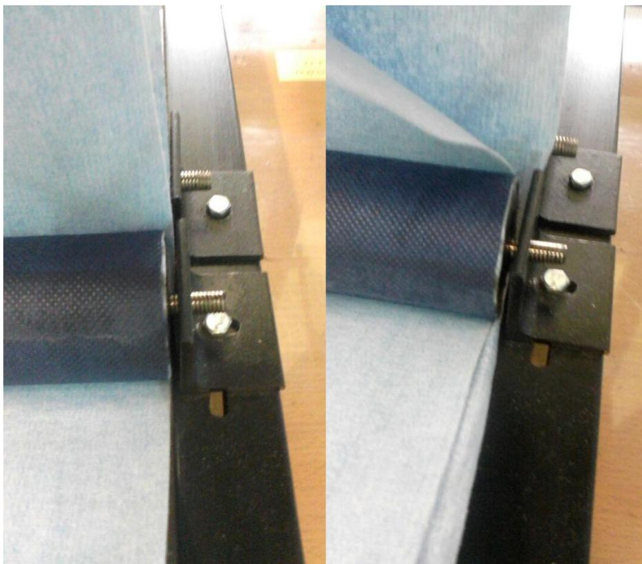
Figura 1.27. El motor no puede en cuanto empieza a haber arruga. Prueba 6
