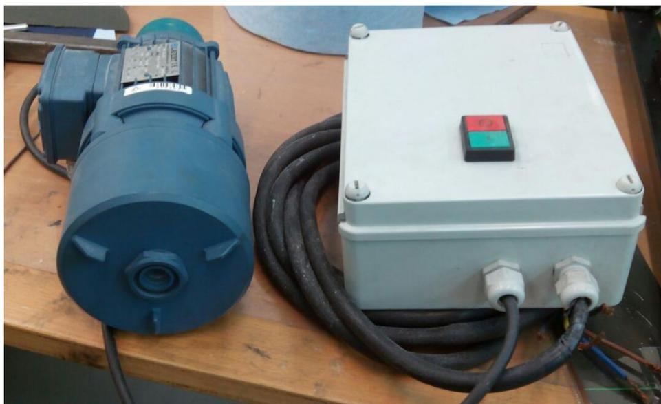
*Figura 1.8. Motor de corriente continua utilizado*
