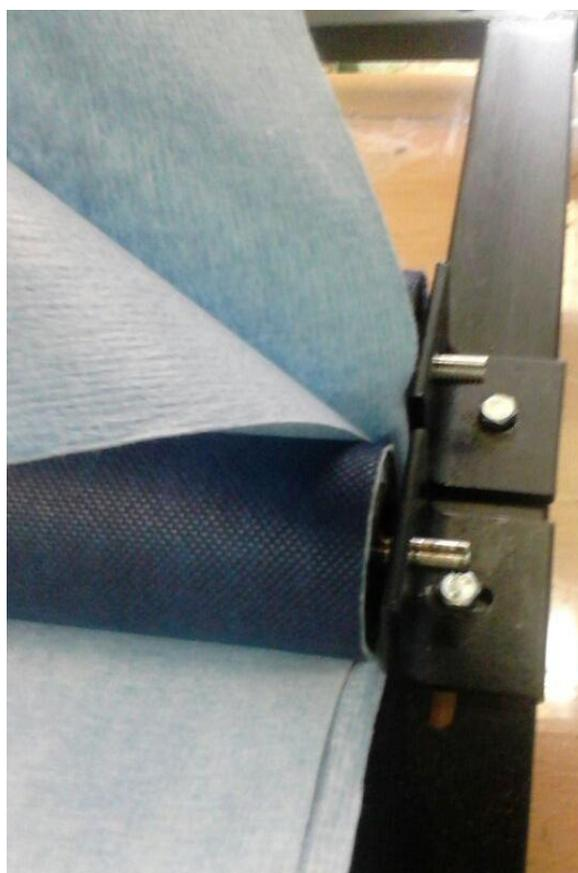
Figura 1.30. El motor no puede en cuanto empieza a haber arruga. Prueba 10
