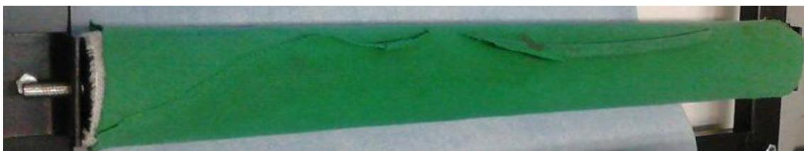
Figura 1.47. Antideslizamiento de los rodillos
