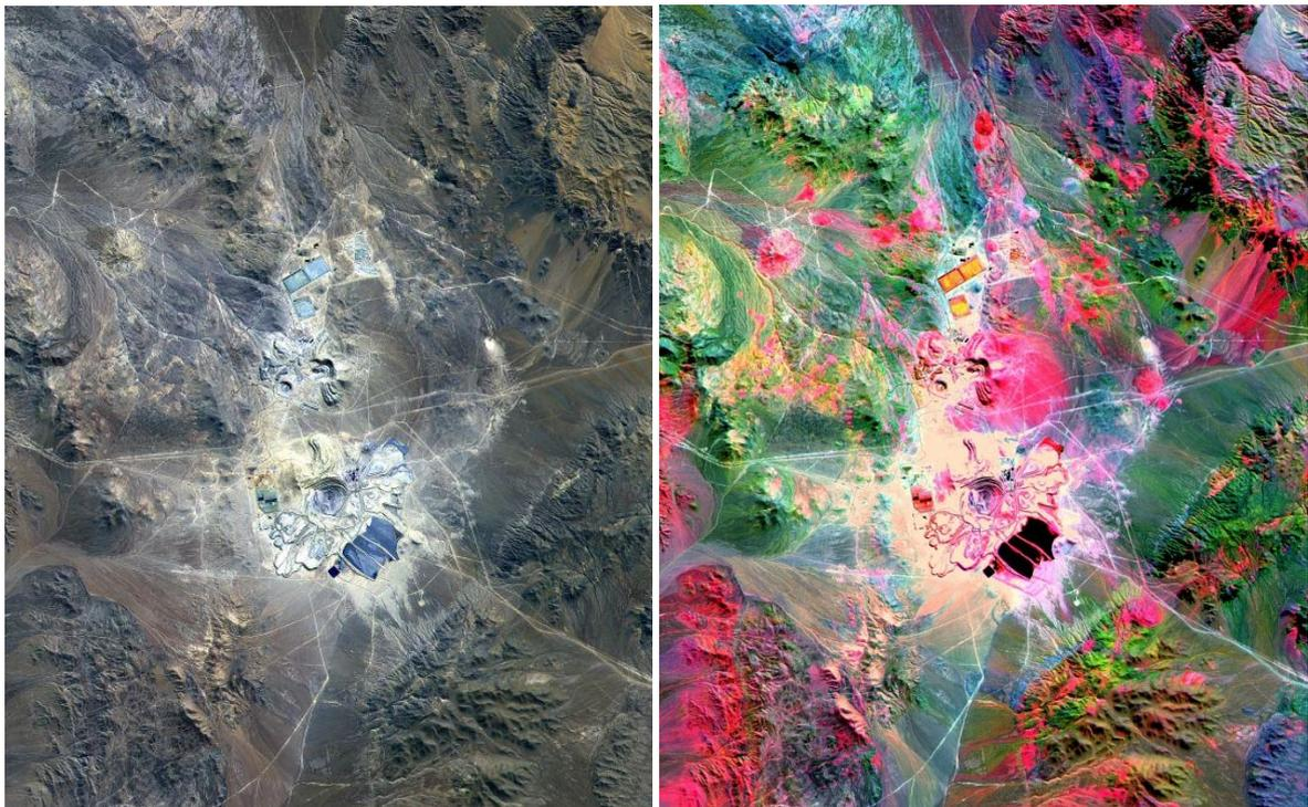
**Figura 56. Mina La Escondida (Chile).** La imagen de la izquierda es un compuesto 3-2-1 RGB convencional. La imagen de la derecha muestra SWIR bandas 4-6-8 en RGB, y pone de relieve las diferencias litológicas y de alteración de las unidades de superficie. La imagen se encuentra en 24,3 grados de latitud sur y 69,1 grados de longitud oeste. Fuente: NASA/METI/AIST/Japan Space Systems, and U.S./Japan ASTER Science Team.
