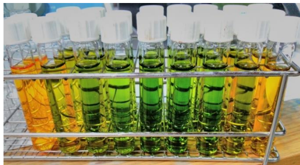
Imagen 4. Fotografía de las diferentes coloraciones posibles en el análisis de la DQO.
