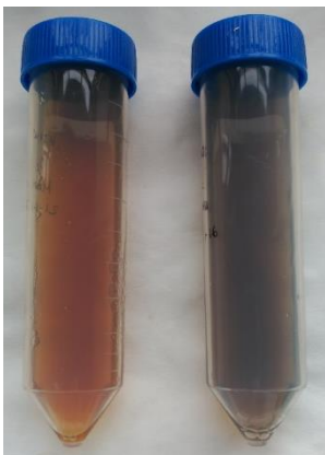
Imagen 14. Tubos con sobrenadante de OH a la izquierda e HT a la derecha. La diferencia en el color evidencia la diferencia entre ambos tratamientos.
