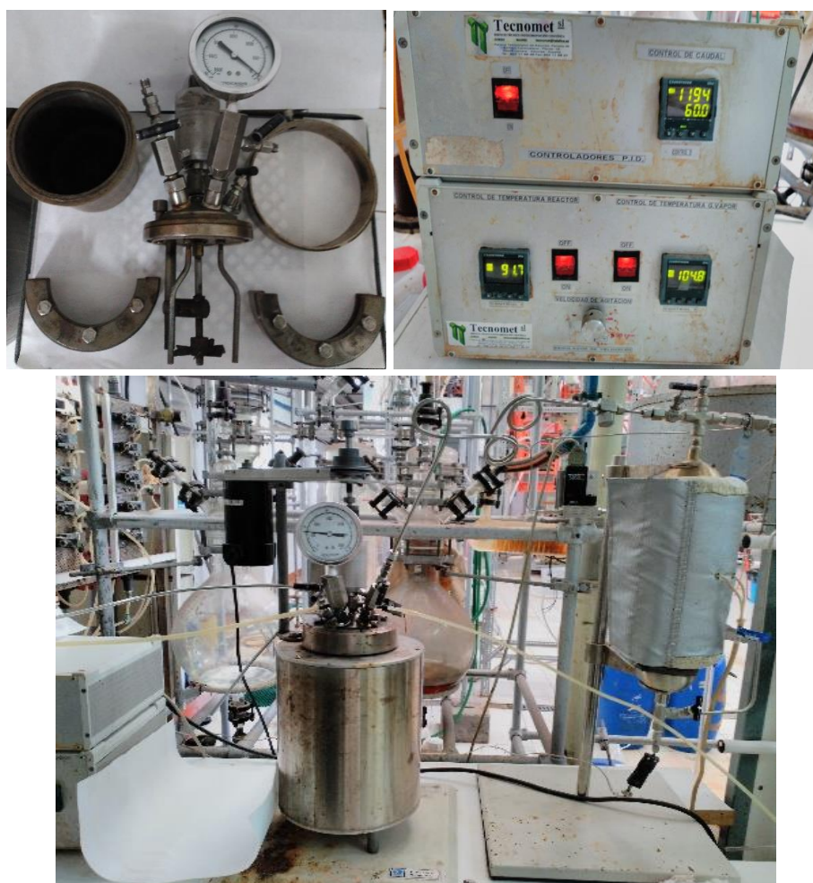
Imagen 2a, 2b y 2c. Fotografías de las partes del reactor (2a, izda.), del controlador PID con los selectores de temperatura, flujo de gas y de velocidad de agitación (2b, dcha.) y del reactor montado y humidificador (2c, abajo).
