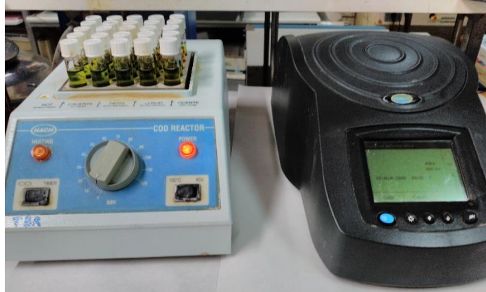
Imagen 5. Equipos utilizados para la medida de la DQO: a la izquierda se encuentra el digestor, y a la derecha el espectrofotómetro utilizado.
