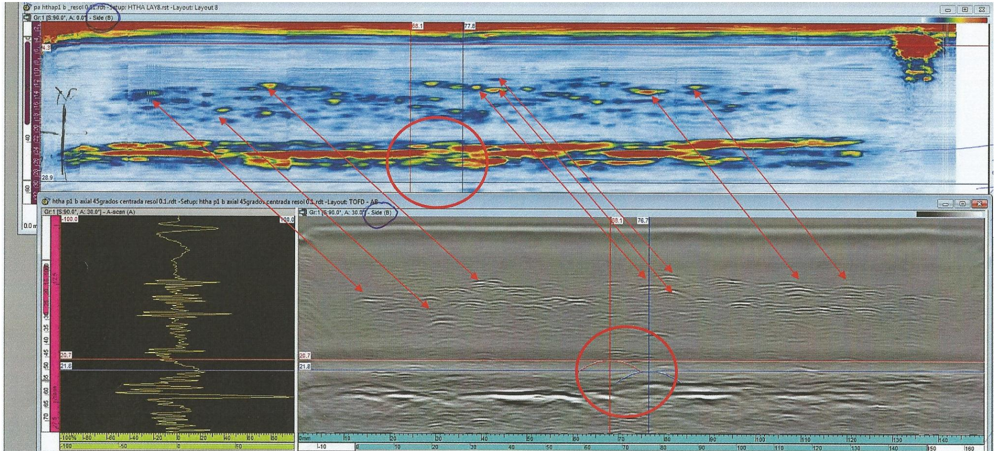
Figura 18.- Indicaciones registradas mediante ensayos no destructivos, técnicas ultrasonidos TOFD y Phased Array. Probeta P1. Inspección desde la cara B.
