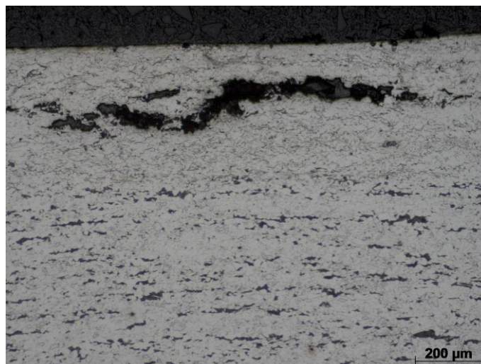
Figura 41.- Metalografía sobre probeta P1, zona X3, superficie B. Nital 2% a 100x.
