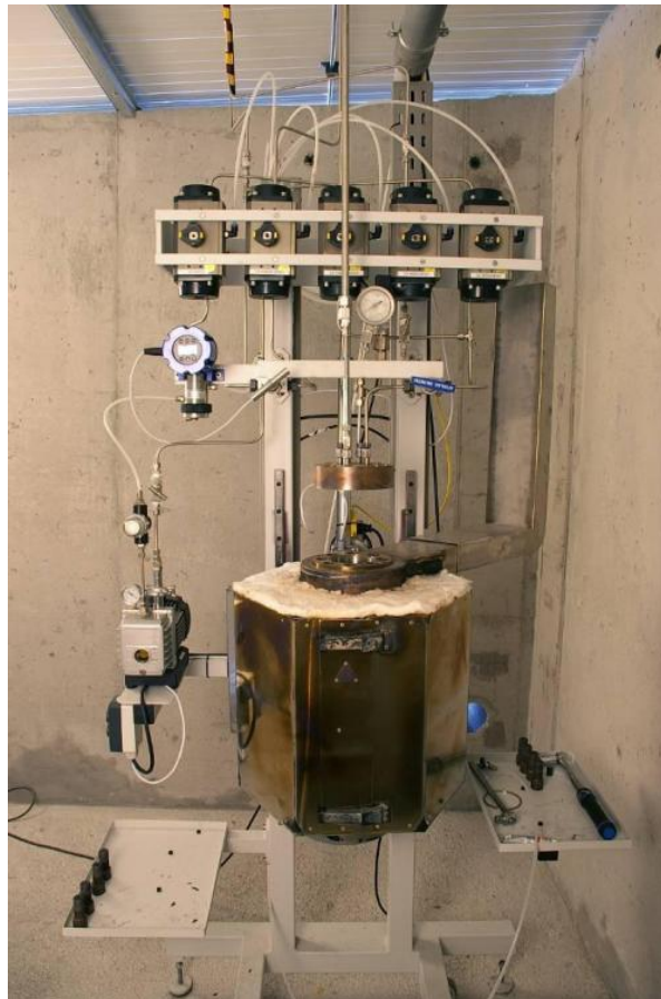
Figura 9.- Reactor para ensayo Disbonding de Fundación ITMA.
