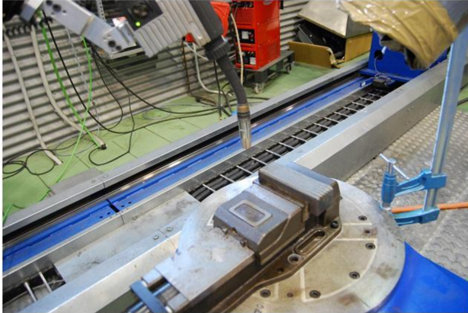
Figura 15.- Recargue por soldeo CMT robotizado de una de las caras de las probetas para HTHA.
