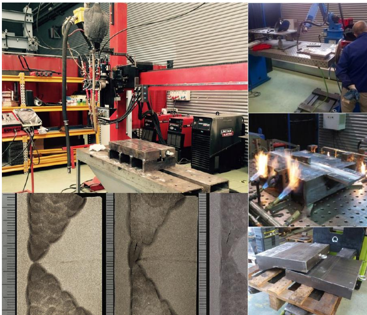
Figura 7.- Fabricación bloques de referencia en planta piloto de soldadura de Fundación ITMA.
