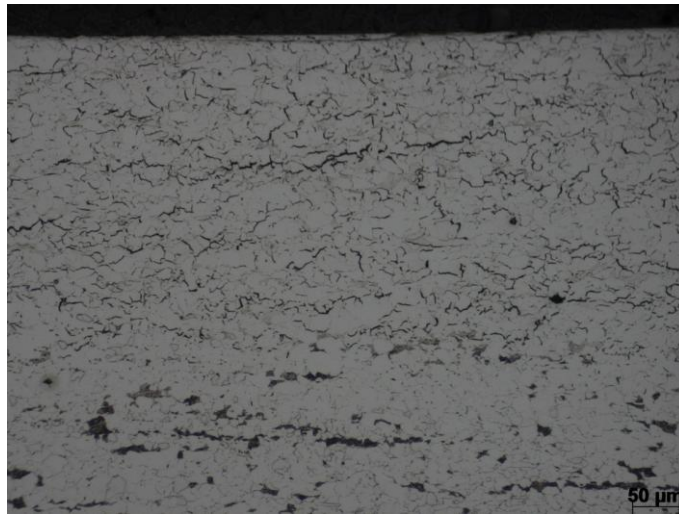
Figura 39.- Metalografía sobre probeta P1, zona X2, superficie B. Nital 2% a 200x.
