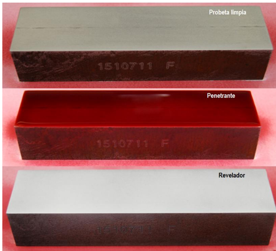
Figura 11.- Sección transversal y líquidos penetrantes sobre la muestra 4096608-1C de acero S355K2.
