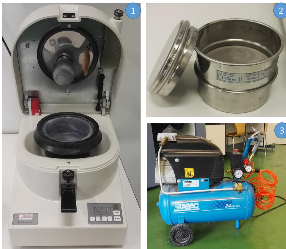
Figura 3.19 (1) Mortero mecánico empleado en la fase de molienda; (2) tamiz de 125 micras; (3) equipo de soplado con aire comprimido
