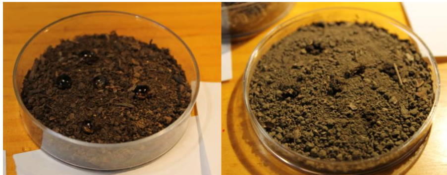
Figura 24. Imágenes tomadas durante la realización del ensayo WDPT donde pueden observarse gotas en la superficie del suelo (izquierda) y gotas que ya se han infiltrado (derecha).
