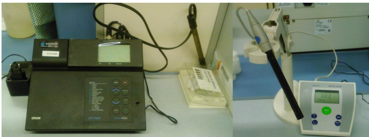
Figura 23. Imagen que muestra el medidor de pH (izquierda) y el conductímetro (izquierda) utilizados para realizar las mediciones.
