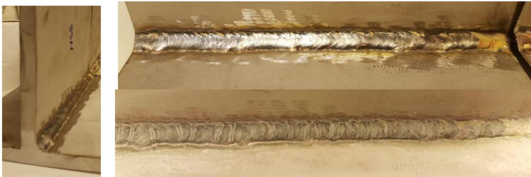
*Figura 36: Soldadura en ángulo con Helistar SS y líquidos penetrantes*
