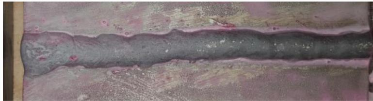
*Figura 34: Soldadura de cordón de recargue con Helistar SS y líquidos penetrantes*
