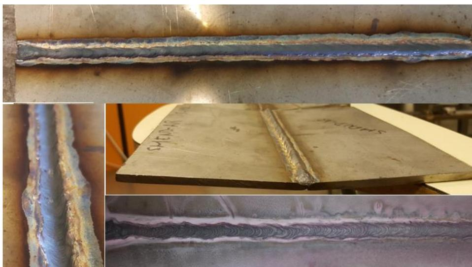
Figura 27: Soldadura en horizontal con Argón y líquidos penetrantes
