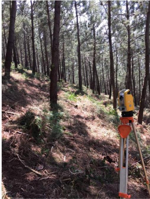
*Figura 11. Trabajos de posicionamiento de árbol individual con estación total.*
