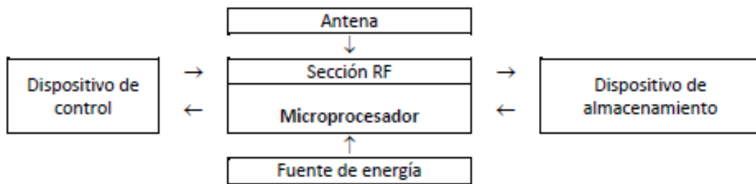
Ilustración 11. Elementos básicos del receptor GPS
