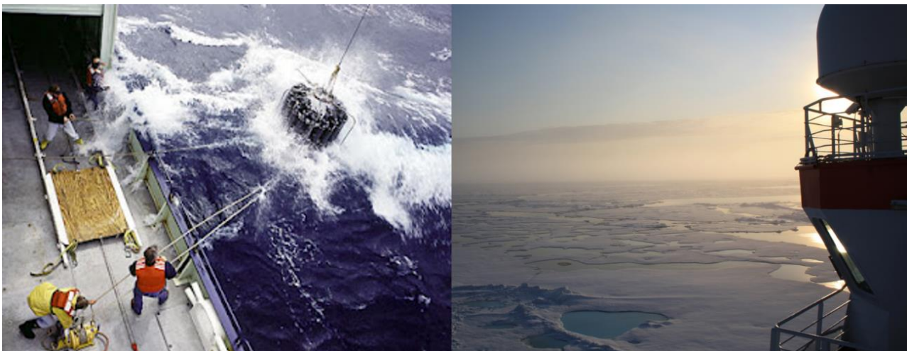
Figura 1.5. Condiciones de mala mar. Recogida de un CTD y de una roseta oceanográfica a bordo de un buque oceanográfico (B.O) ( izquierda ) y cobertura de hielo en el Ártico ( derecha ). (Fuente: Raquel Somavilla).
