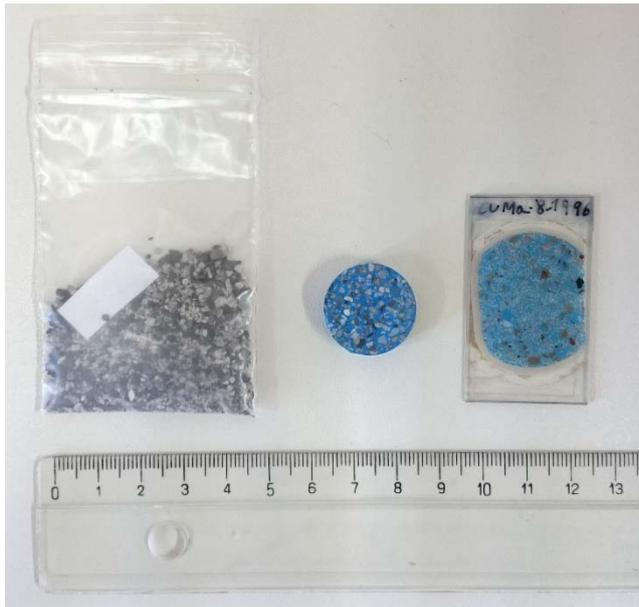
Figura 7. Aspecto de los ripios de sondeo en cada una de las fases de preparación. En primer lugar al llegar al laboratorio, posteriormente su aspecto al realizar la probeta y finalmente la lámina delgada).
