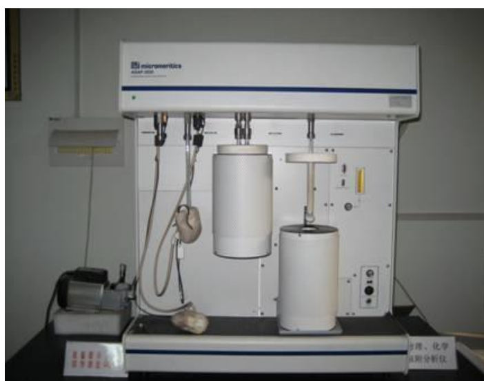
Fig. 9. Equipo utilizado para realizar fisisorción de nitrógeno.
