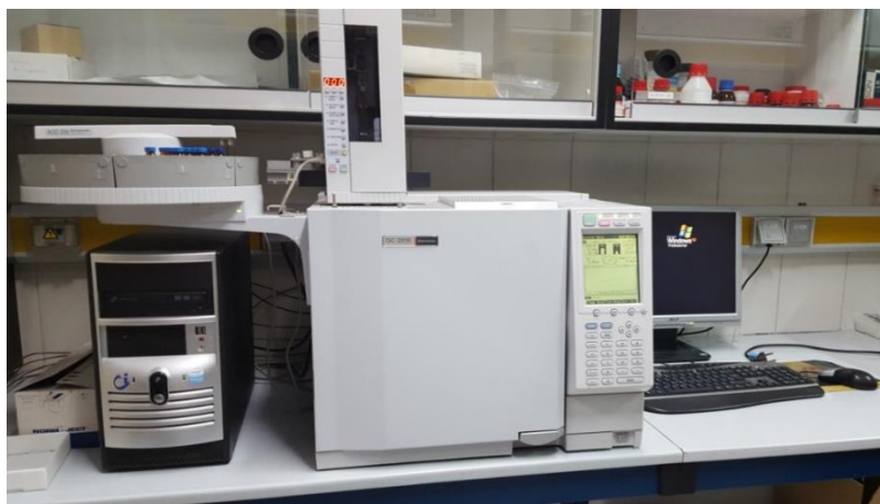
Fig. 12. GC-FID utilizado para el análisis de muestras líquidas de reacción.
