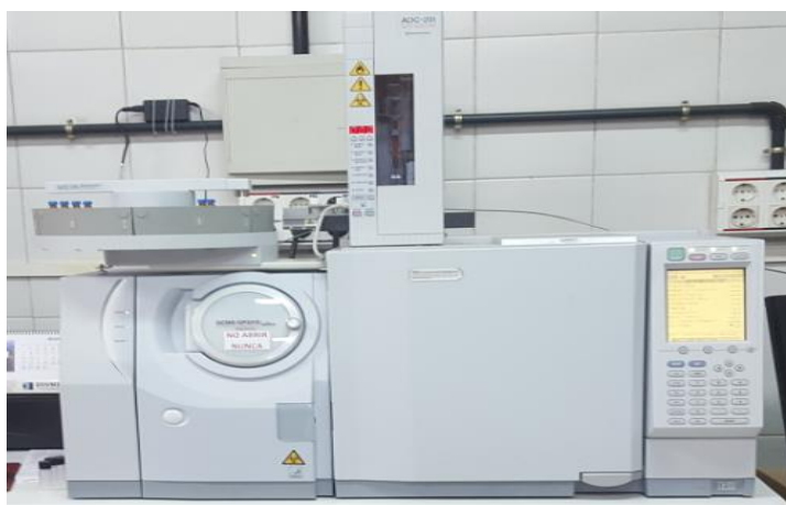
Fig. 14. GC-MS utilizado para la identificación de los distintos productos de reacción.
