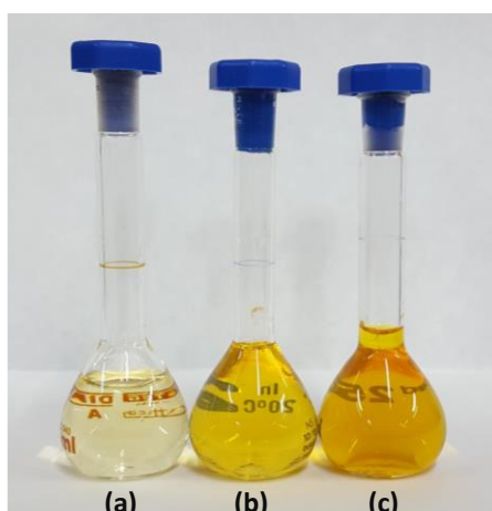
Fig. 19. Muestras de reacción: (a) muestra inicial y muestras a las 24 h con distintos catalizadores: (b) Mg-Al y (c) Mg-Zr.
