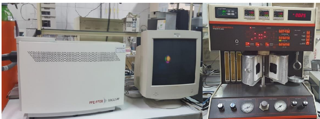
Fig. 10. Dispositivo experimental para llevar a cabo los ensayos de temperatura programada.
