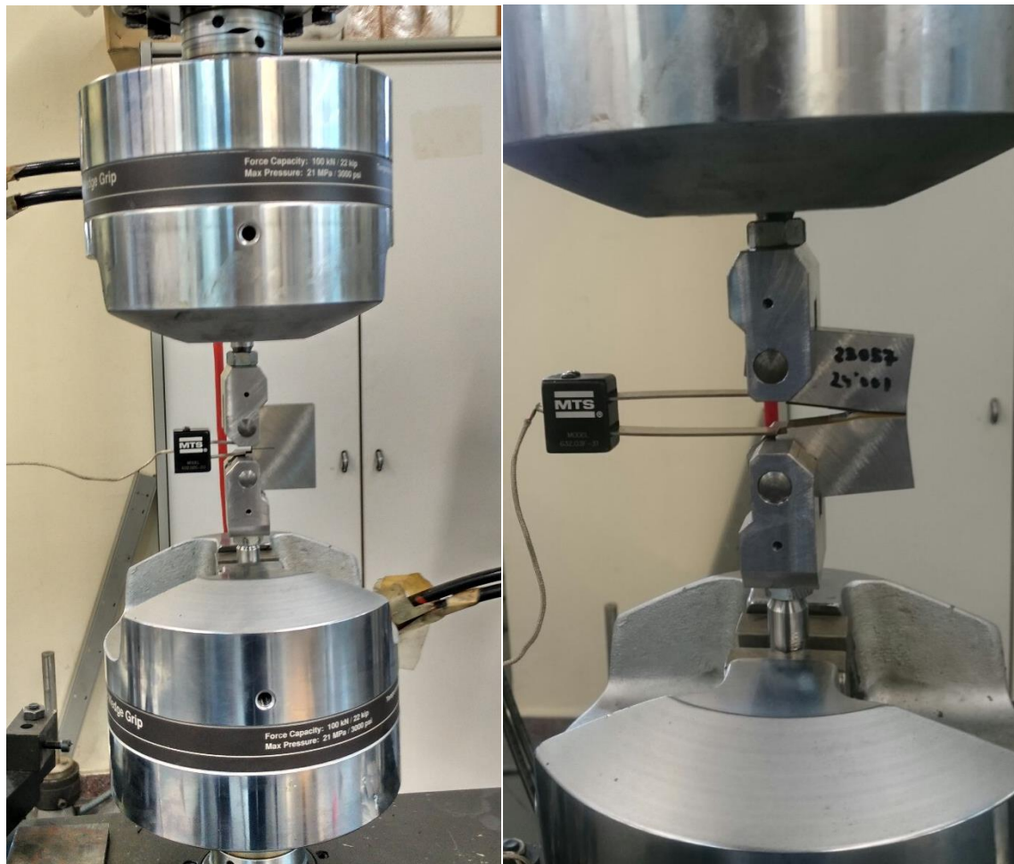
Figura 3.9. Pregrietamiento (izquierda). Ensayo de fractura (derecha). Es interesante observar la zona plástica formada en el frente de grieta en el ensayo de fractura.
