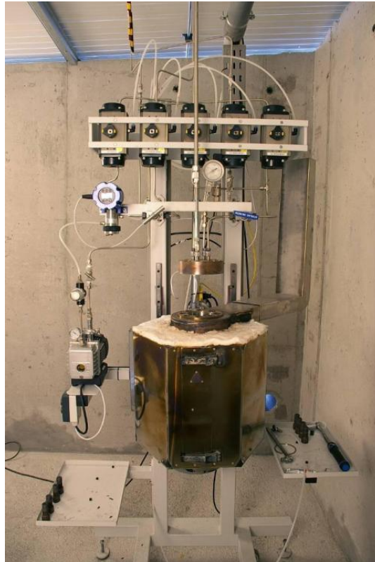
Figura 3.10. Reactor de hidrógeno del ITMA [36].
