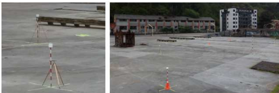
Figura 12: Disposición de los reflectores cilíndricos colocados sobre los GCP
